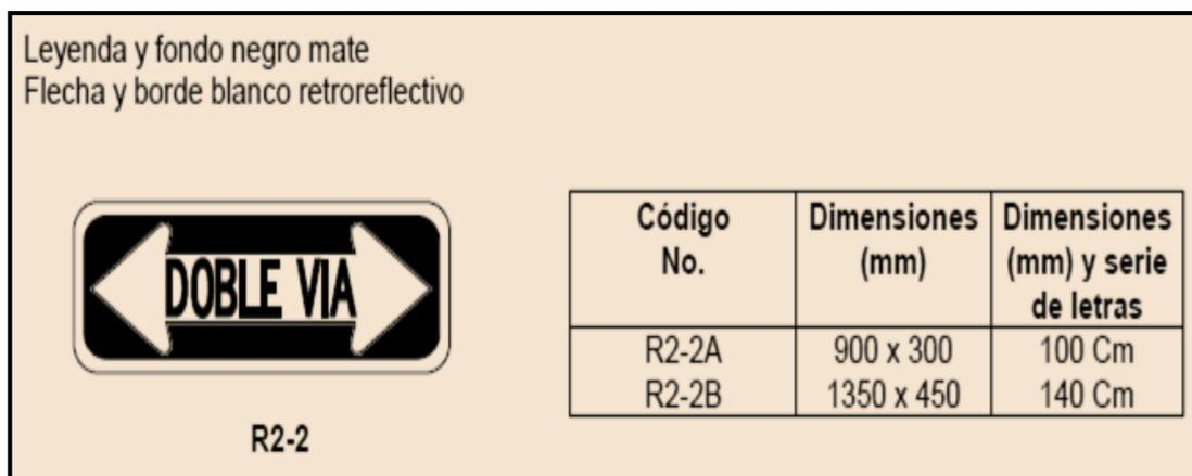
Ilustración 12: Diseño doble vía.
