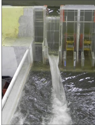
Fotografía No 4.13: Chorro producido por la pared derecha en el esquí.
