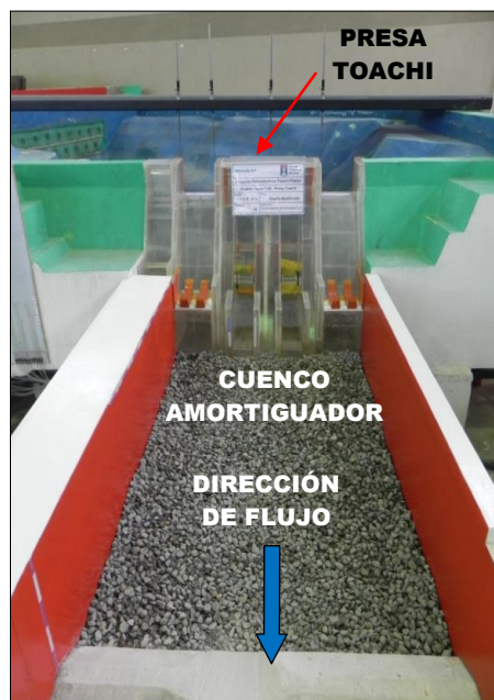
Fotografía No 4.3: Modelo físico de la Presa Toachi.
