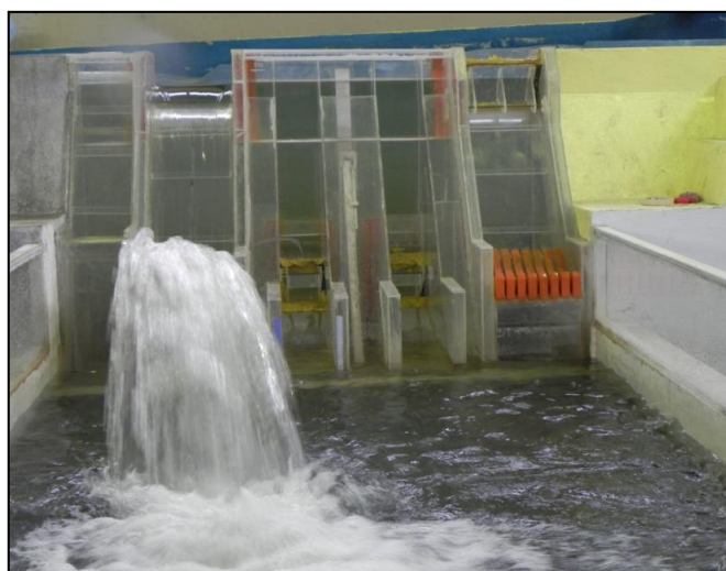
Fotografía No 4.14: Chorro generado por el deflector de altura variable.
