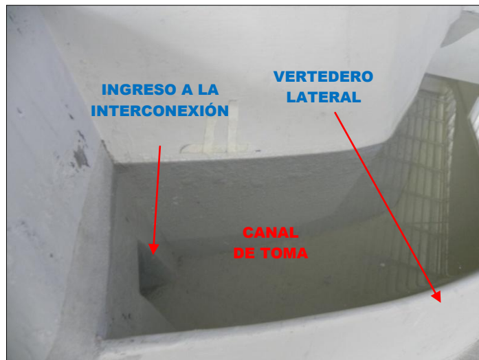
Fotografía No 4.5: Modelo físico del canal y bocatoma
