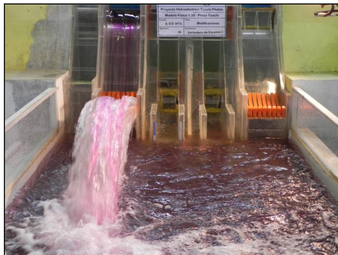
Fotografía No 4.11: Chorro producido por el deflector dentado.
