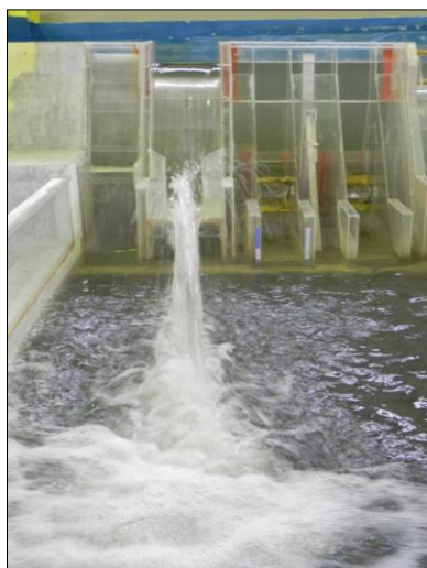
Fotografía No 4.12: Chorro generado por las paredes convergentes.
