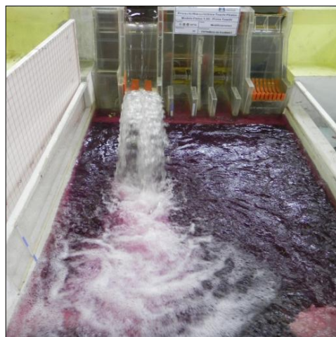
Fotografía No 4.16: Chorro generado por el deflector discontinuo y contracción.
