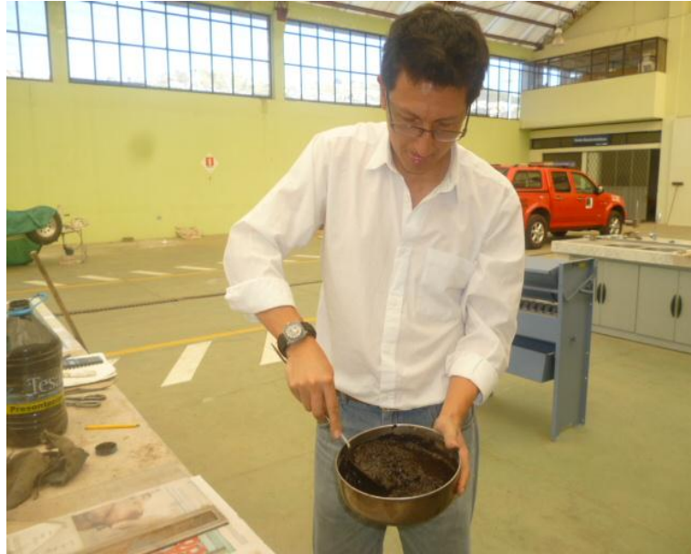
Fotografía 5. 21: Preparación de la mezcla de micro pavimento
