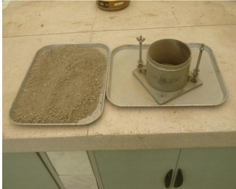
Fotografía 3. 7: Agregado seleccionado y molde para el ensayo
