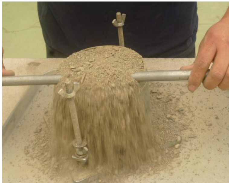
Fotografía 3. 8: Enrasado de la última capa
