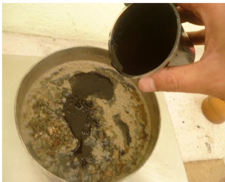
Fotografía 5. 2: Colocación del porcentaje teórico de emulsión
