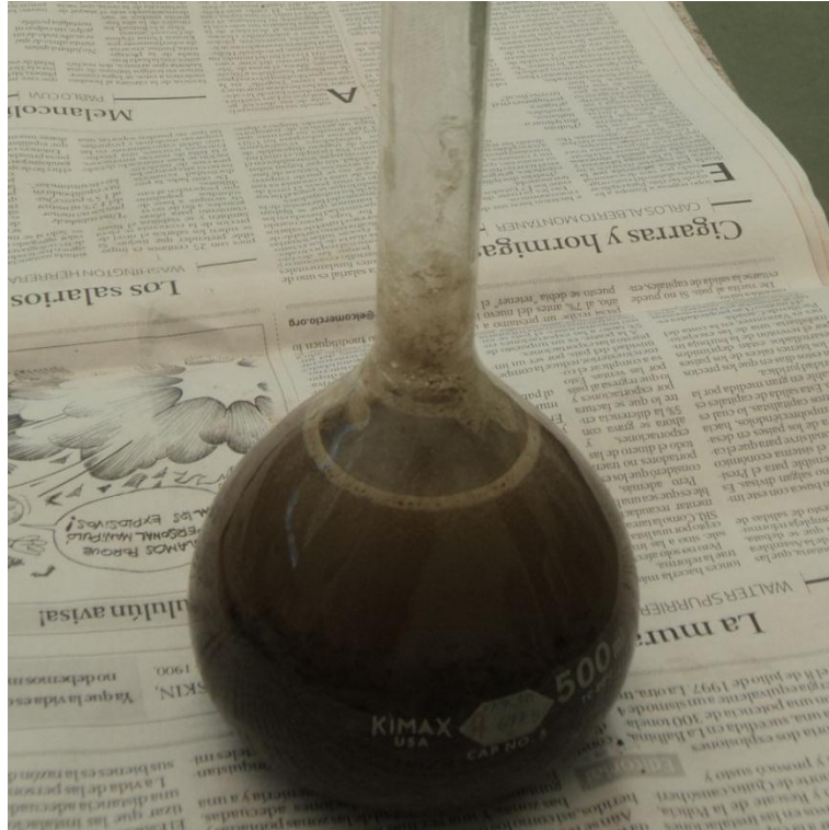
Fotografía 3. 15: Eliminación de burbujas de aire
