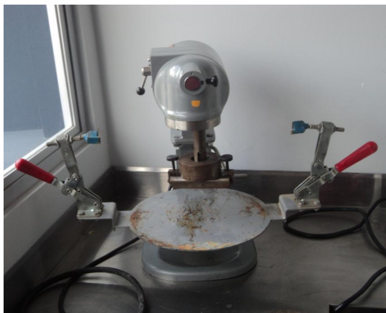
Fotografía 5. 14: Agitador Mecánico molde N - 50
