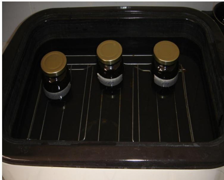
Fotografía 4. 2: Colocación de las muestras para el ensayo en baño maría
