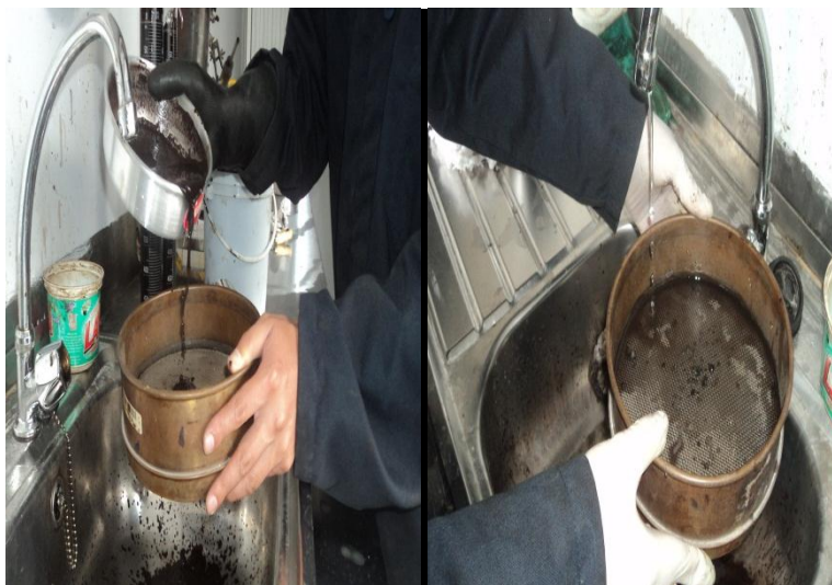
Fotografía 4. 18: Vertido de la mezcla sobre el tamiz y lavado
