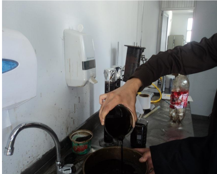
Fotografía 4. 10: Vertido de la emulsión sobre el tamiz
