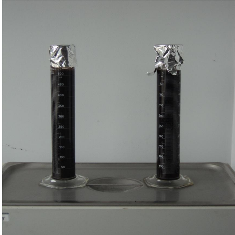
Fotografía 4. 5: Reposo de las probetas durante 24 horas
