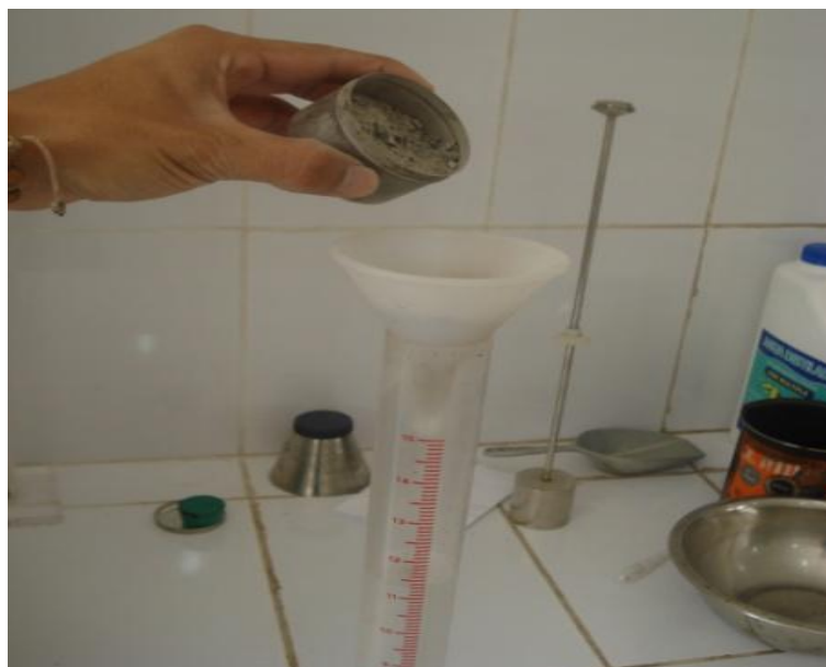
Fotografía 3. 23: Vertido de la muestra preparada
