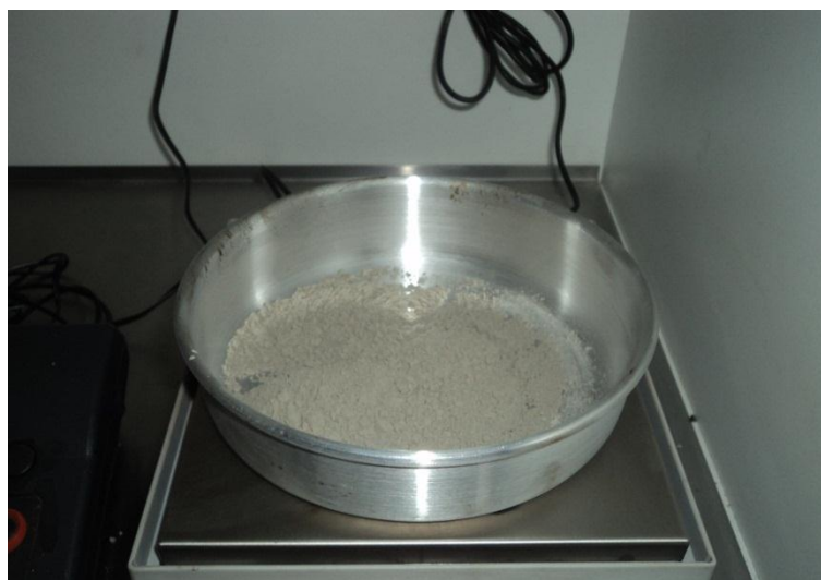
Fotografía 4. 16: Cemento tamizado y pesado
