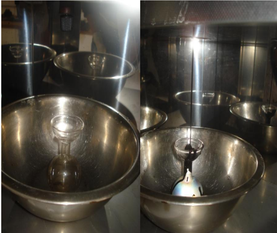
Fotografía 4. 4: Alineación del corcho con el vaso receptor y Flujo de la emulsión a través del viscosímetro al vaso receptor una vez retirado el corcho.
