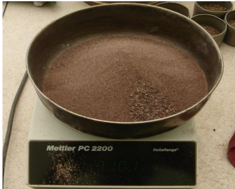
Fotografía 3. 5: Masa total después del tamizado
