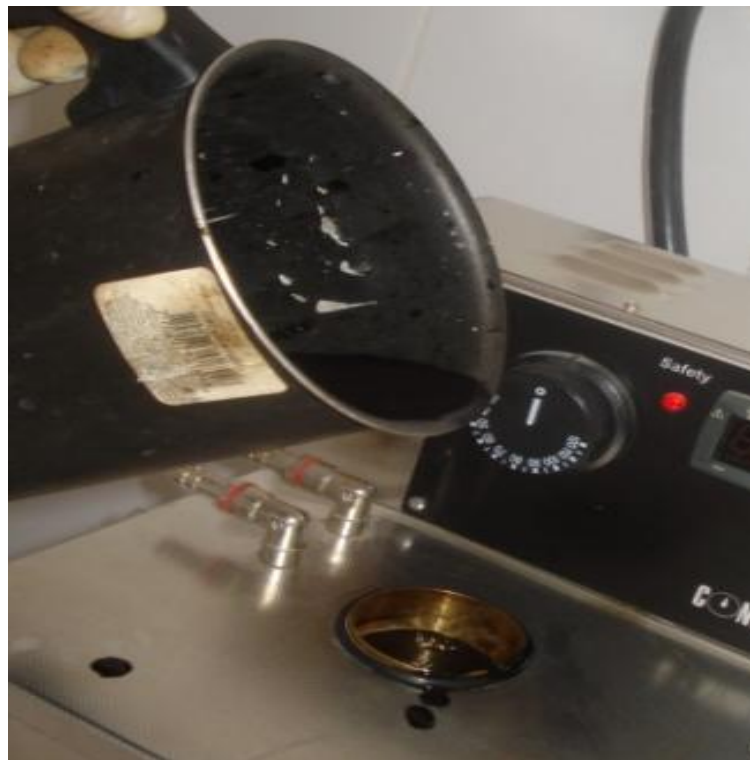
Fotografía 4. 3: Llenado del viscosímetro con la muestra a ensayar
