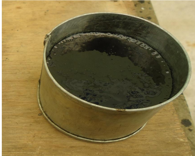
Fotografía 4. 26: Muestra enfriada al ambiente dentro del molde
