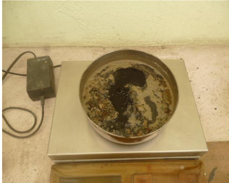
Fotografía 5. 15: Peso de agregado, cemento, agua y emulsión
