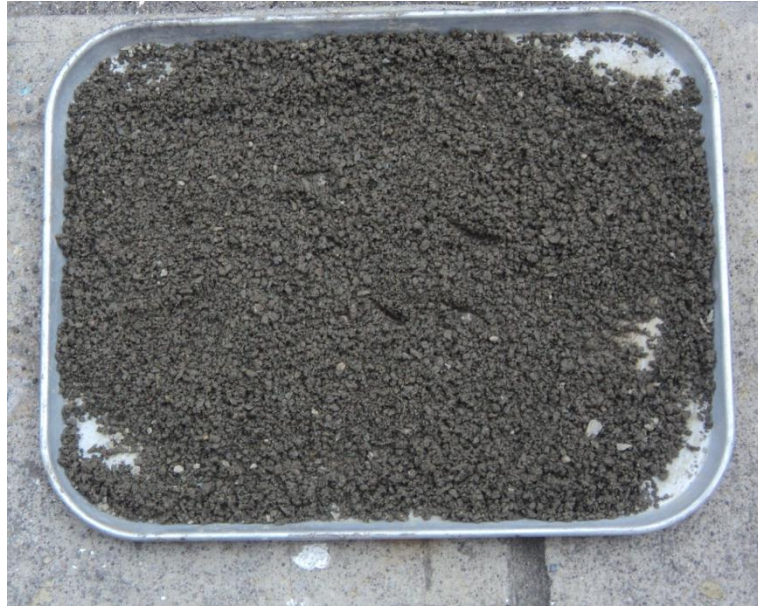
Fotografía 3. 13: Secado de la muestra al aire libre
