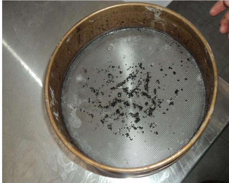
Fotografía 4. 12: Muestra de residuo retenida en el tamiz finalizado el ensayo
