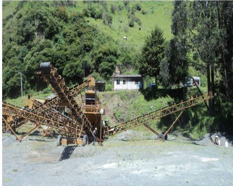
Fotografía 3. 1: Muestreo desde la banda transportadora
