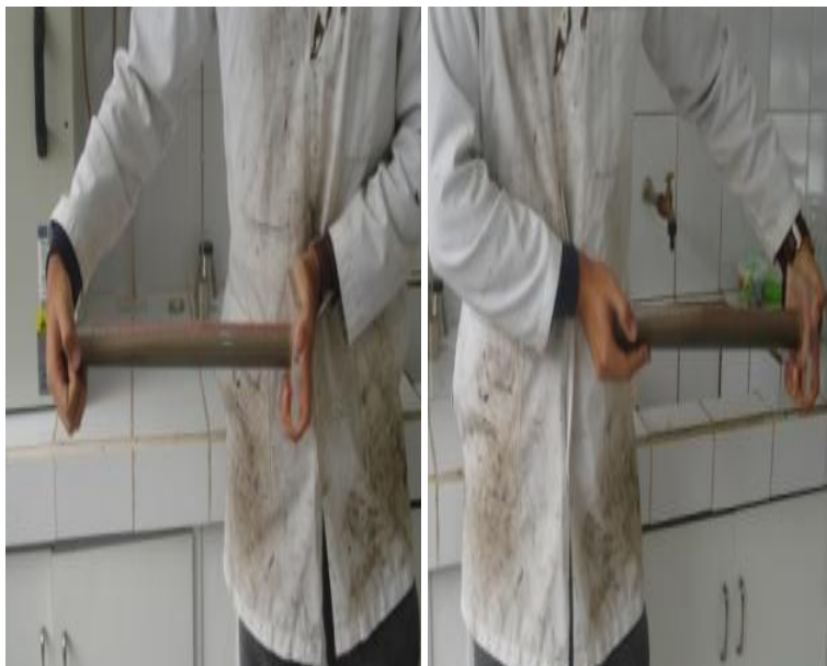
Fotografía 3. 24: Agitación de la probeta de izquierda a derecha
