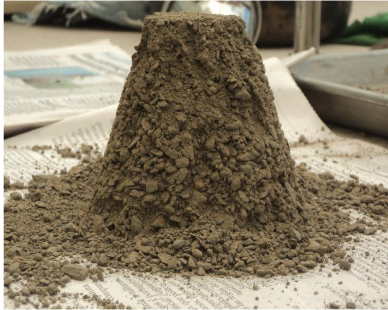
Fotografía 3. 14: Muestra saturada superficie seca
