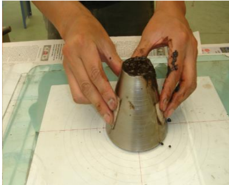
Fotografía 5. 3: Mezcla de micro pavimento en el interior del molde
