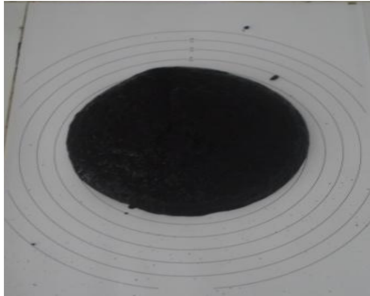
Fotografía 5. 5: Medición de la fluencia de la mezcla
