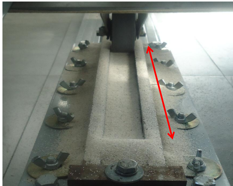
Fotografía 5. 26: Rueda a 100 ciclos, vertida arena Ottawa
