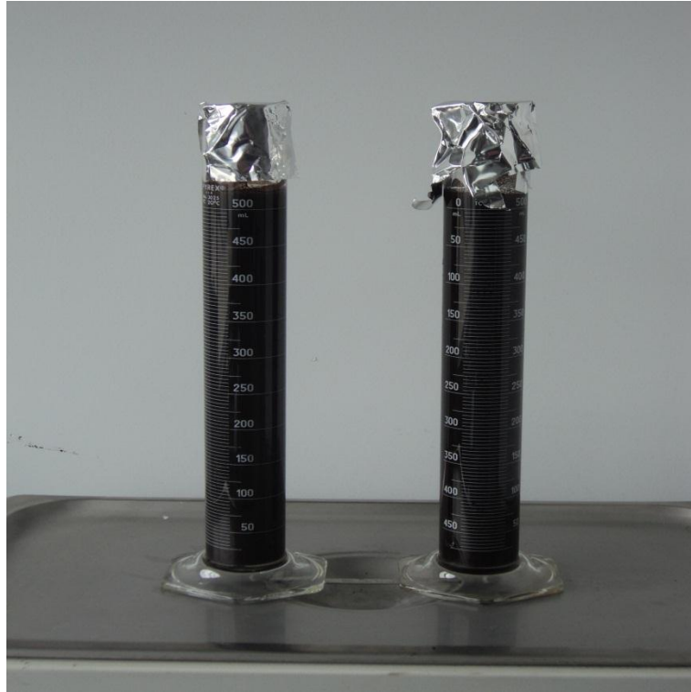
Fotografía 4. 8: Reposo de las probetas durante los 5 días
