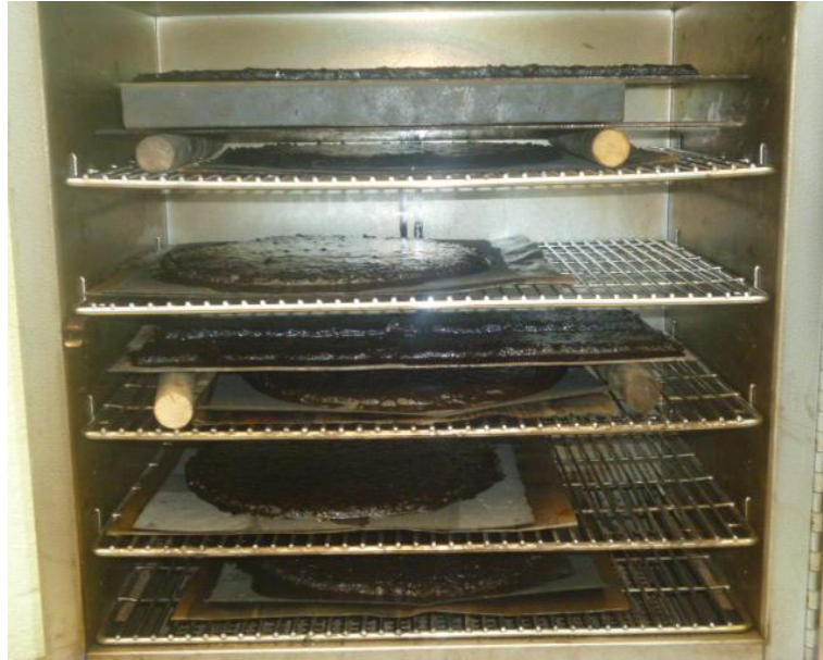
Fotografía 5. 17: Colocación de las muestras al horno a 60°
