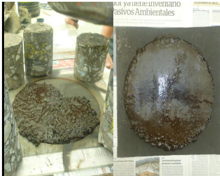
Fotografía 5. 16: Colocación de la mezcla en el molde y muestra en reposo
