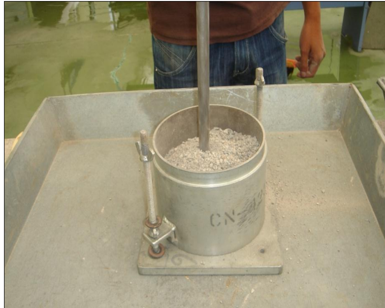
Fotografía 3. 9: Apisonamiento de la muestra
