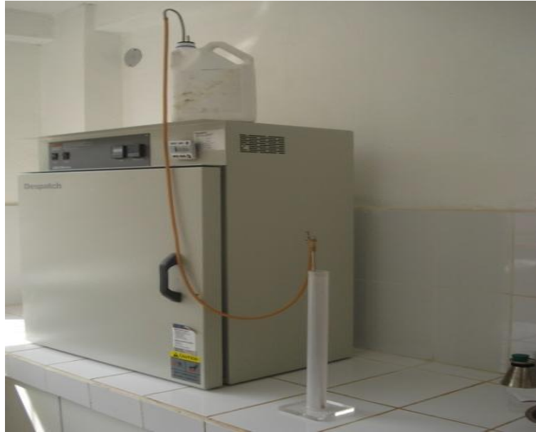
Fotografía 3. 22: Equipo de sifonamiento
