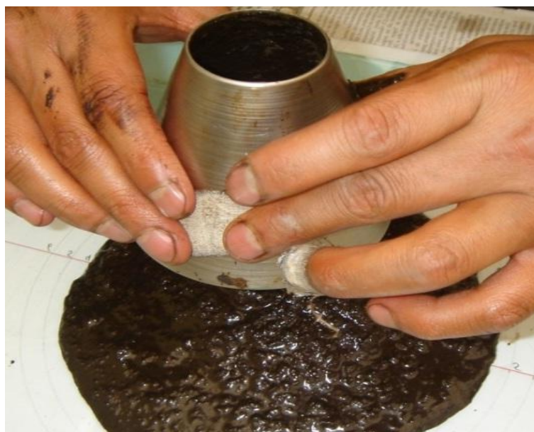
Fotografía 5. 4: Levantada del molde cónico
