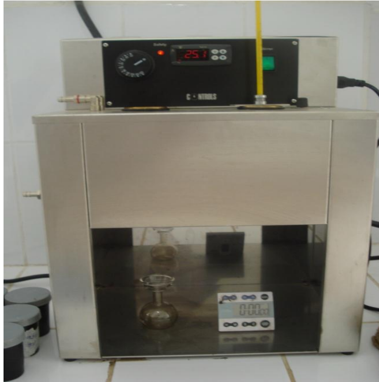
Fotografía 4. 1: Viscosímetro Saybolt Furol calibrado a 25°C
