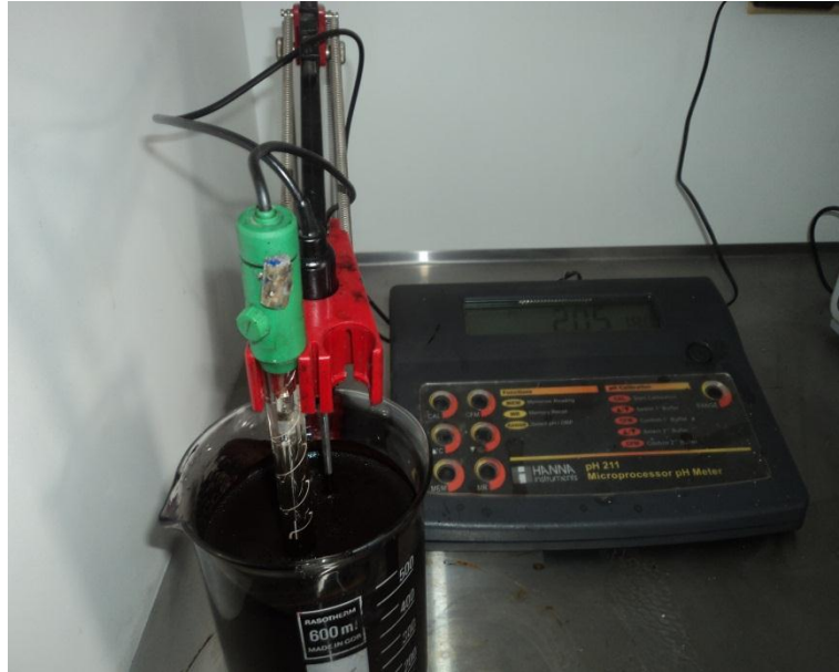
Fotografía 4. 20: Colocación del pH – metro electrónico en la emulsión
