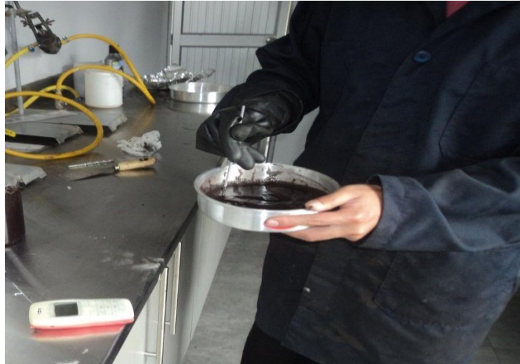
Fotografía 4. 17: Mezcla de emulsión, cemento y agua
