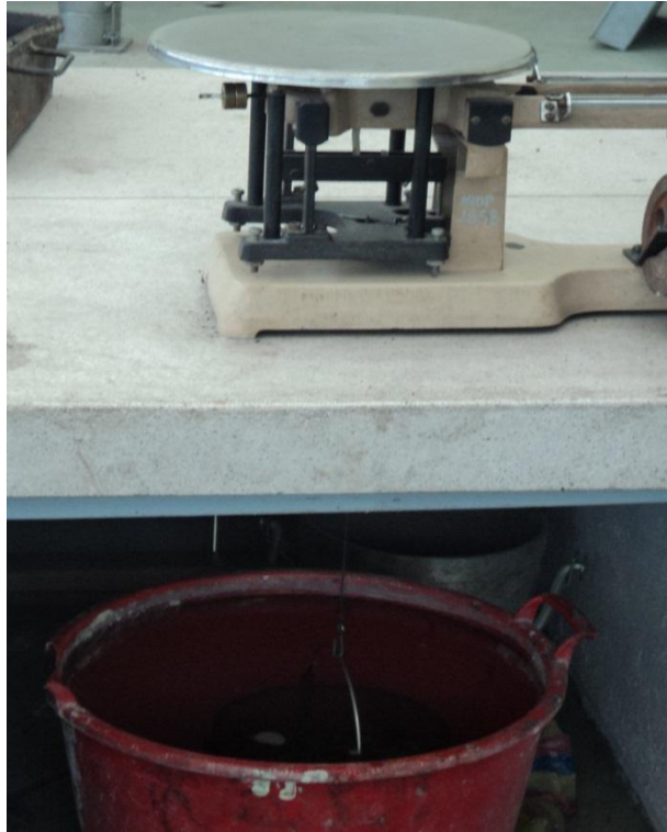
Fotografía 3. 18: Determinación de la masa sumergida en agua
