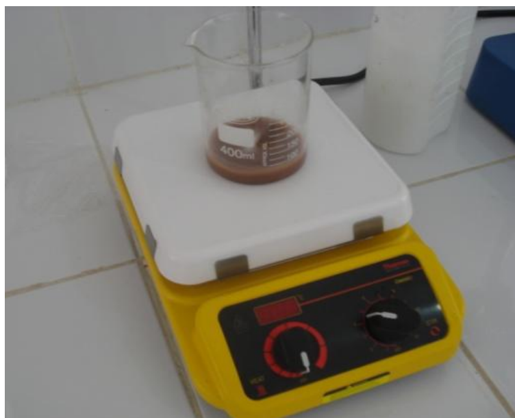
Fotografía 3. 19: Agitación magnética de la muestra
