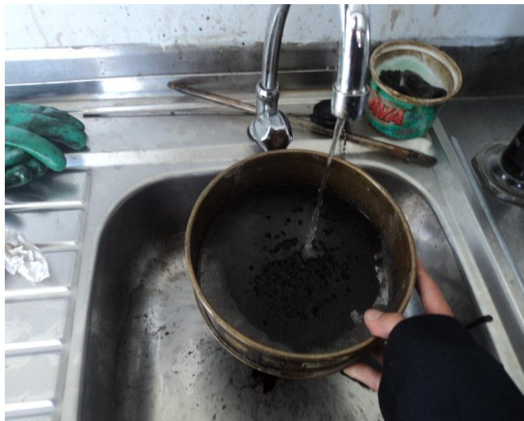
Fotografía 4. 11: Lavado del tamiz hasta que el agua salga clara
