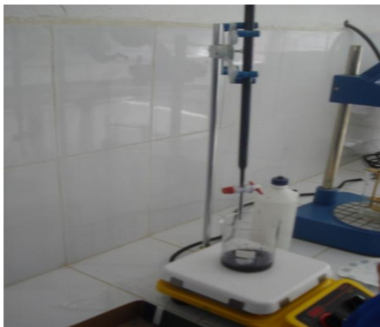
Fotografía 3. 20: Adición de azul de metileno
