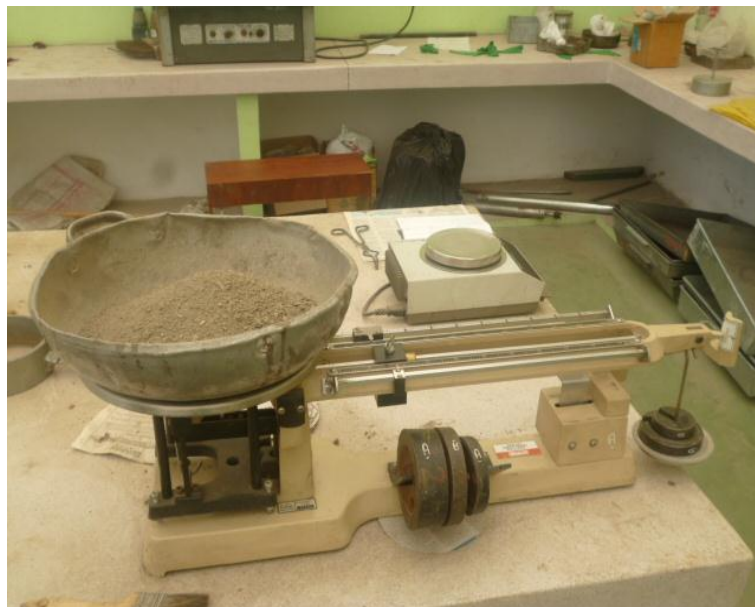
Fotografía 3. 6: Peso del agregado para el ensayo
