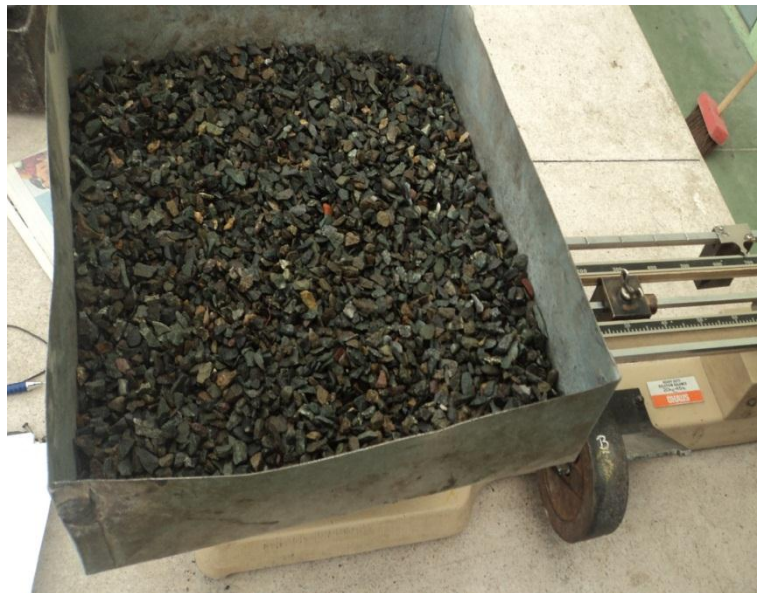
Fotografía 3. 17: Peso de la masa en estado saturada con superficie seca
