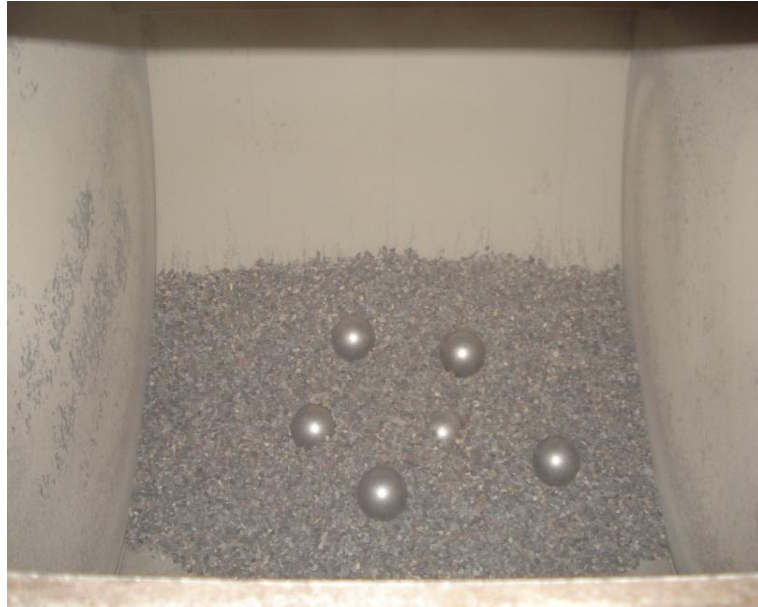
Fotografía 3. 10: Agregado y carga abrasiva
