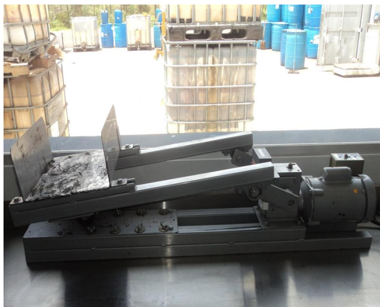
Fotografía 5. 20: Máquina de ensayo de rueda cargada
