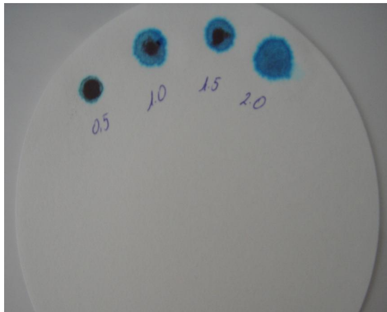
Fotografía 3. 21: Punto final del ensayo de MB
