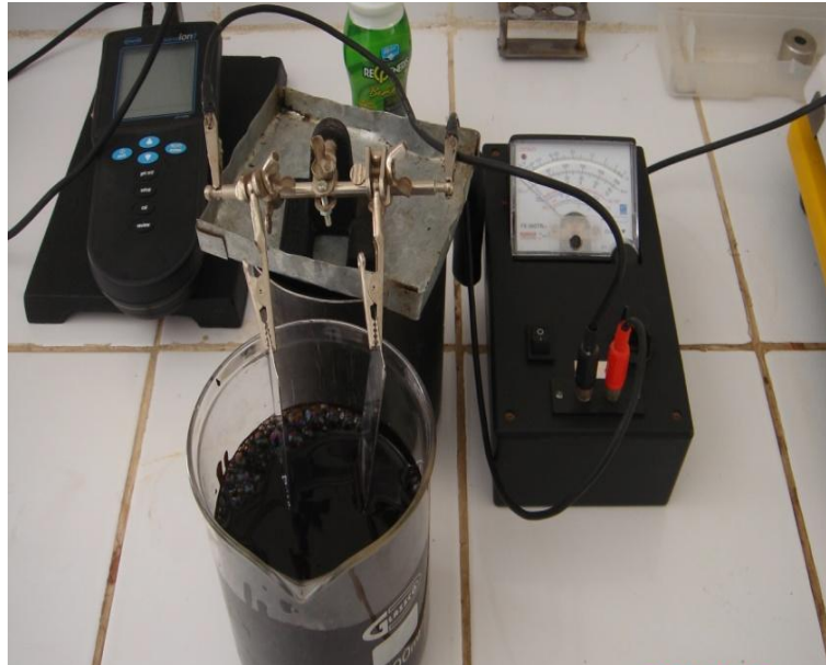
Fotografía 4. 14: Conexión de los electrodos a la fuente y realización del ensayo
