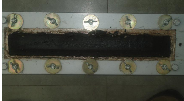
Fotografía 5. 23: Montaje de la briqueta
