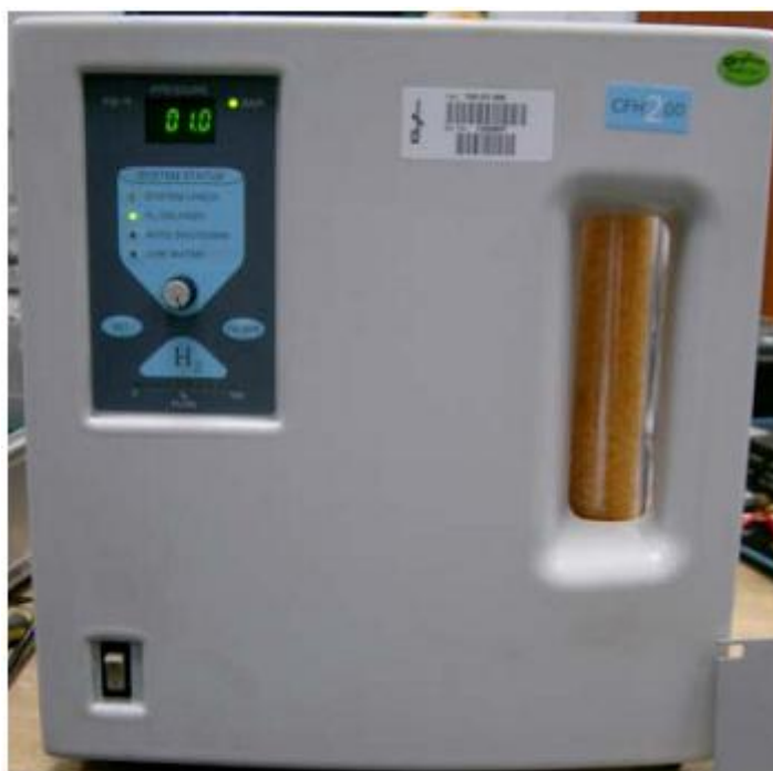
Fig. 17. Generador de Hidrógeno, Equipo de Geoservices.
