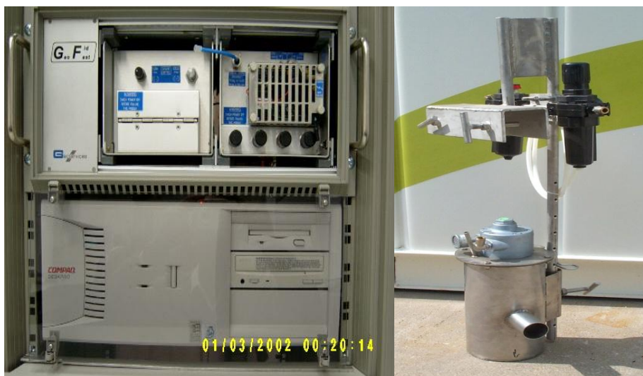
Fig. 16. Cromatógrafo (izquierda) y Desgasificador (derecha), Equipos de Geoservices.
