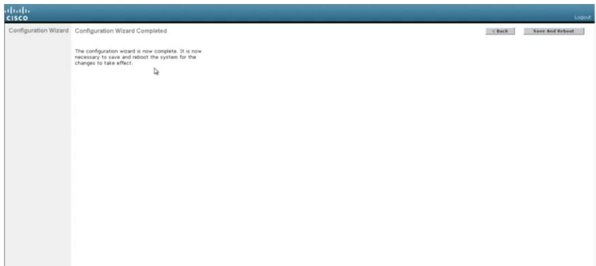
Figura 4.26 Guardar configuraciones del controlador
