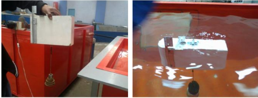
Figura 2. 22. Construcción de Modelos para ensayos en posición vertical.
