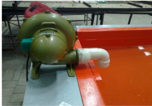
Foto 2. 4.. Aparato generador de olas artificiales en la bandeja.
