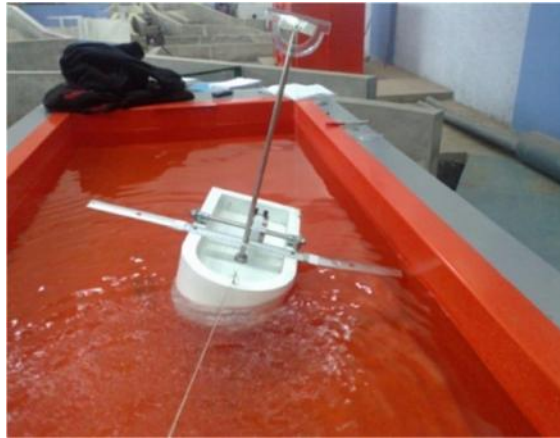
Foto 3. 1. Determinación de la altura metacéntrica en cuerpos flotantes de madera.
