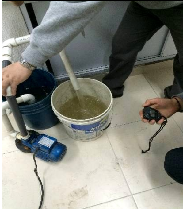
Figura 13. Toma de datos caudal volumétrico.
