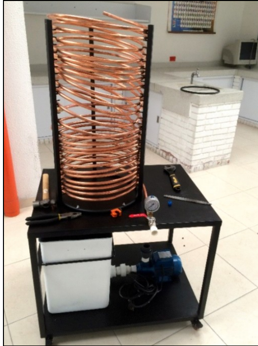
Figura 18. Instalación empates tubería cobre.
