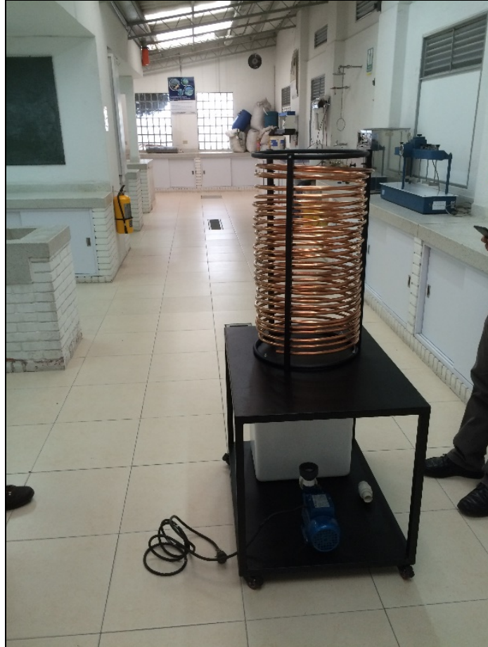
Figura 17. Mesa montaje definitivo y ubicación de tanque y bomba.
