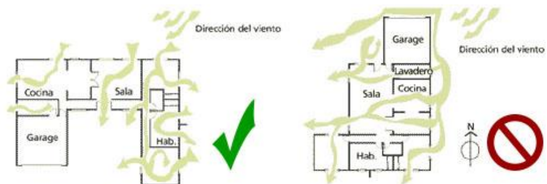
Figura 2. Esquema de planta con ventilación cruzada.
