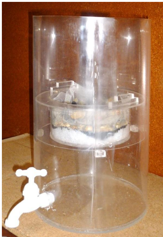
Foto 47 Montaje final filtro natural
