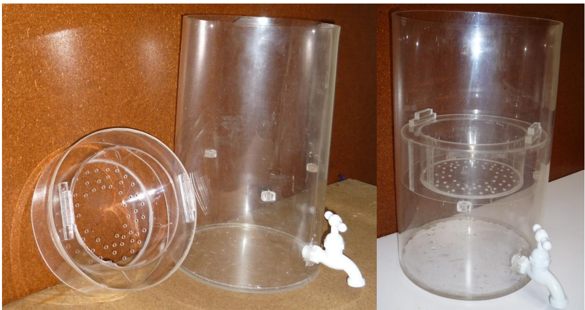
Foto 41 Prototipo del filtro natural
