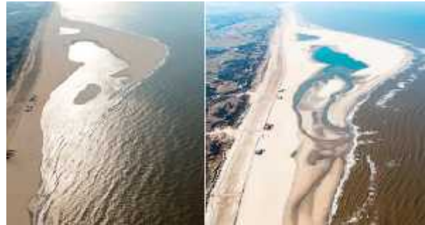
Imagen 3. Vista aérea del método Sand motor, Holanda.
