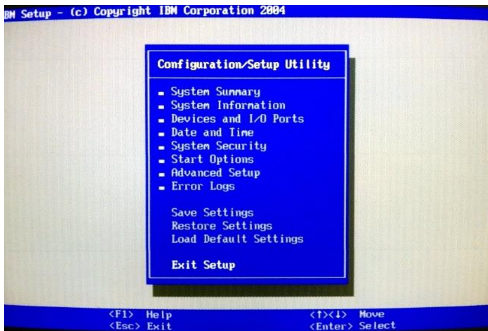
Figura 12. Acceso al BIOS del servidor
