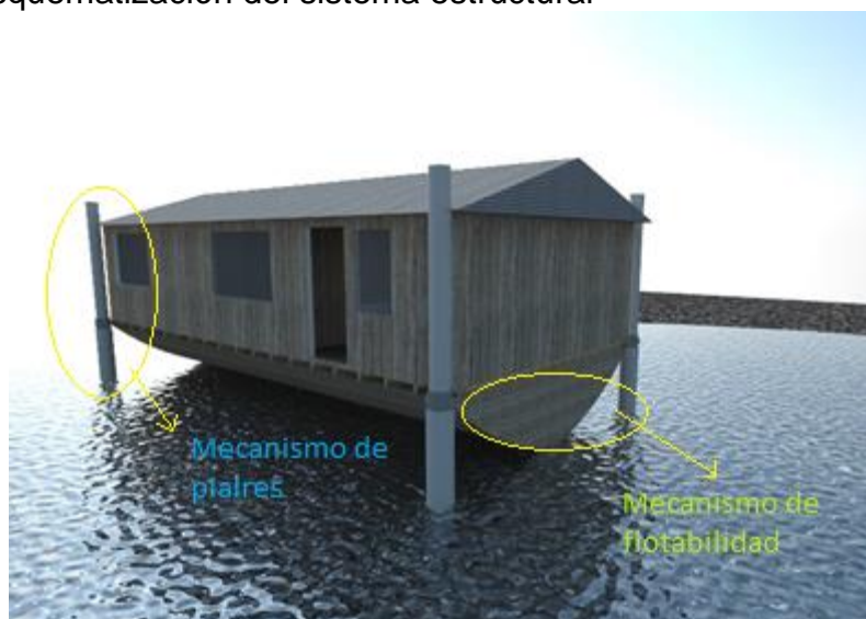
Figura 25. Esquematización del sistema estructural
