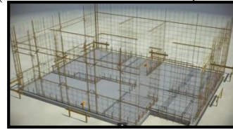
Figura 9. Instalación de refuerzo para muro en concreto (Malla electrosoldada)
