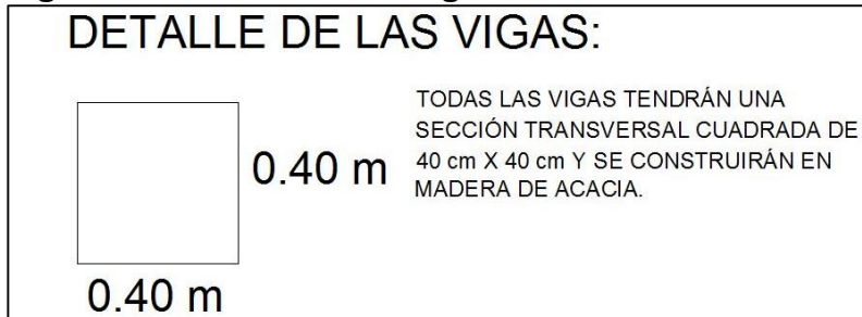
Figura 10. Detalle de las vigas
