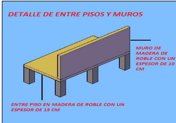
Figura 15. Detalle de Entre Pisos y Muros
