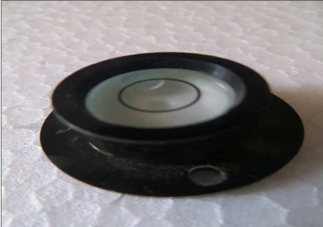
Figura 182. Ojo de Pollo para Garantizar que la Base del Equipo este Nivelada
