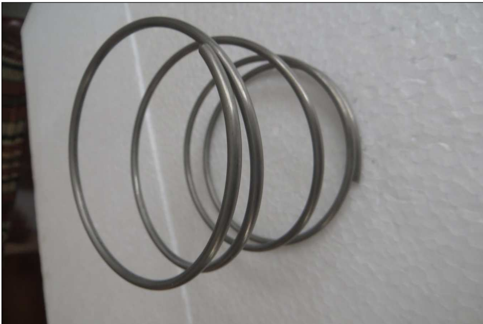
Figura 9. Resorte en Acero Inoxidable, para Fijar las Piedras Porosas a la Muestra
