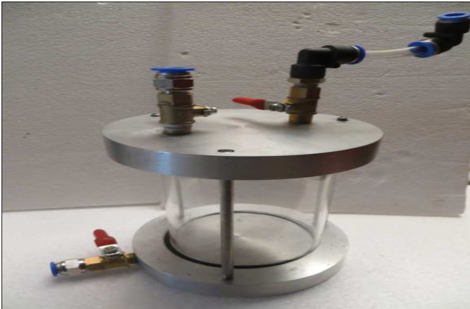
Figura 25. Base Inferior, Válvula, Tornillos, Oring, Molde y Tapa Superior con sus Válvulas de Entrada de Agua y de Purga.
