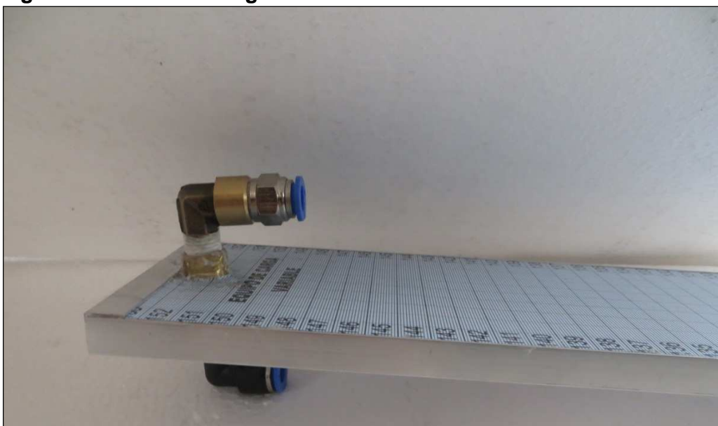
Figura 17. Entrada de Agua.
