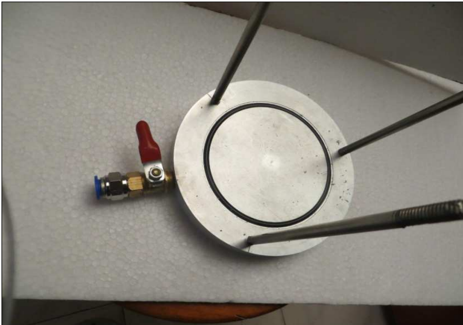
Figura 23. Base en Aluminio con Aro Sello (oring), con Válvula, Tornillos en Acero Inoxidable
