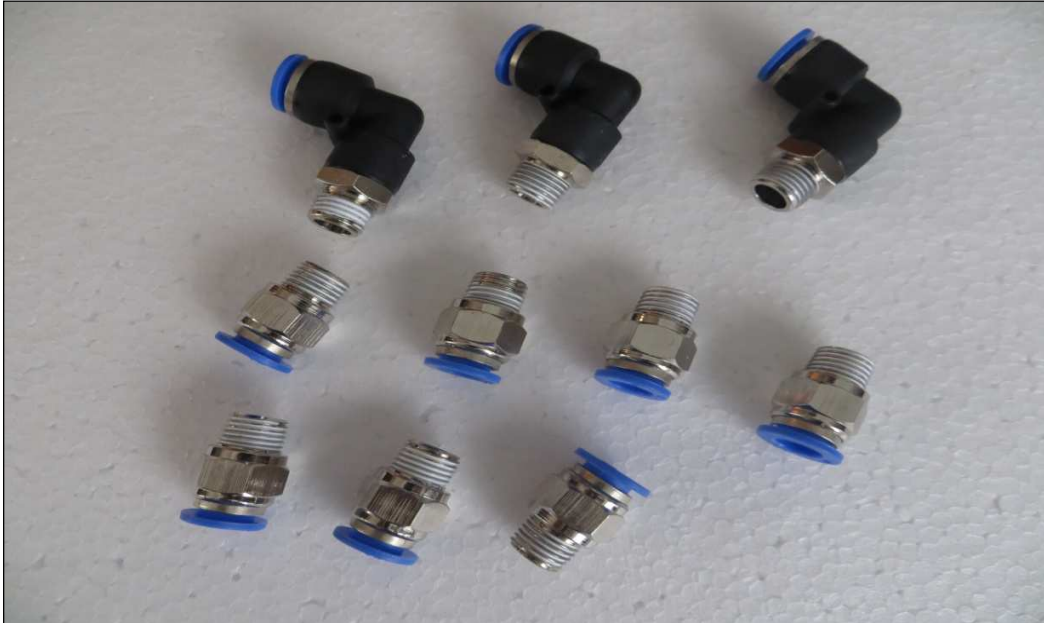
Figura 6. Accesorios en Acero Inoxidable (Codos y Válvulas de Sello Rápido) para Conexiones de las Mangueras
