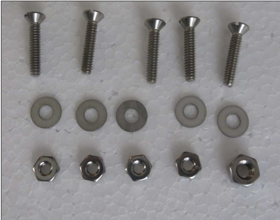
Figura 4. Tornillos de 1" de Largo x 3/16" con Arandela y Tuerca en Acero Inoxidable. Para Ajuste de la Cuadrícula a la Base del Equipo y el Perfil de Aluminio
