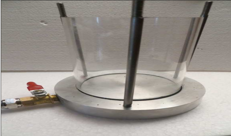
Figura 24. Base en Aluminio, con Válvula, Aro Sello, Tornillos y Molde en Acrílico donde se va a Colocar la Muestra para Ensayo.
