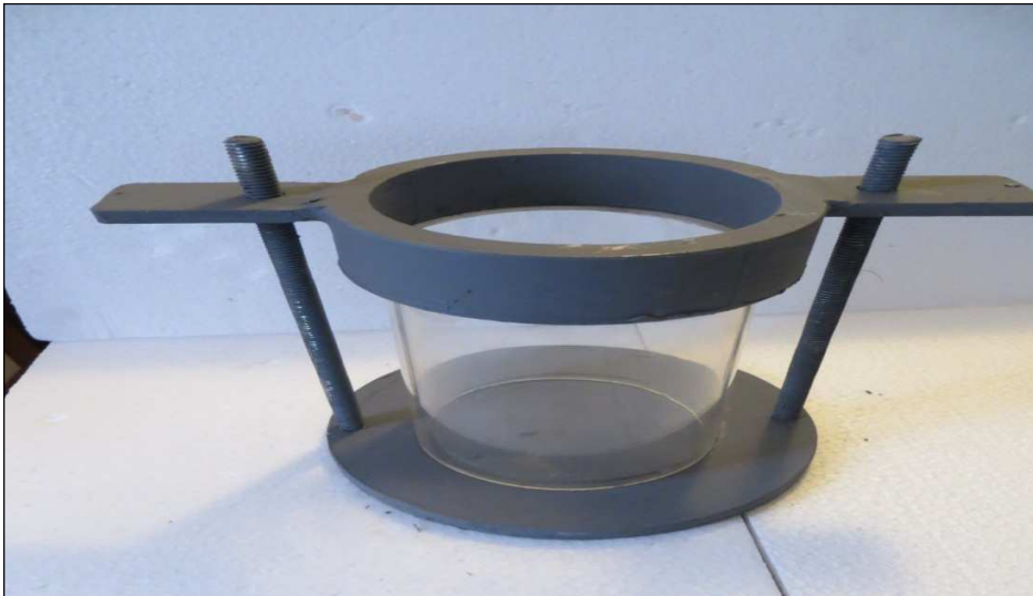
Figura 20. Molde para Compactar las Muestras
