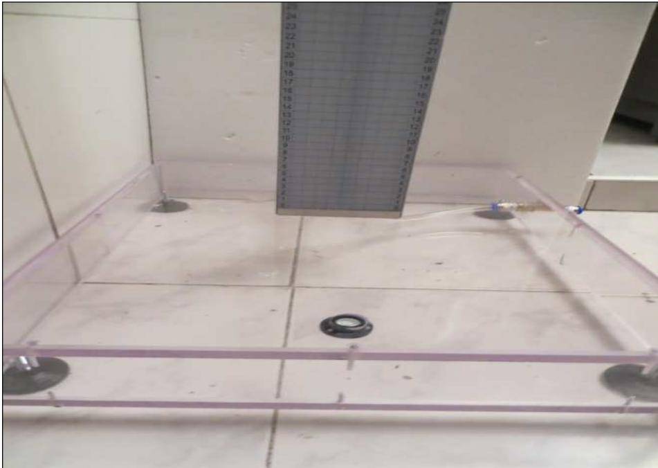
Figura 22. Base con el Ojo de Pollo para Garantizar la Nivelación de la Misma
