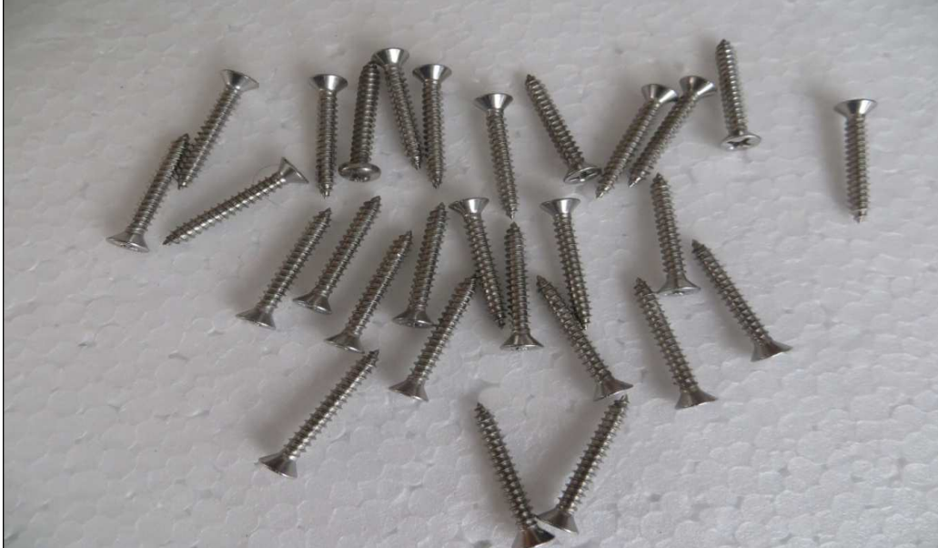
Figura 10. Tornillos de 1" x 1/8" en Acero Inoxidable, para el Armado de la "Caja" Base del Equipo
