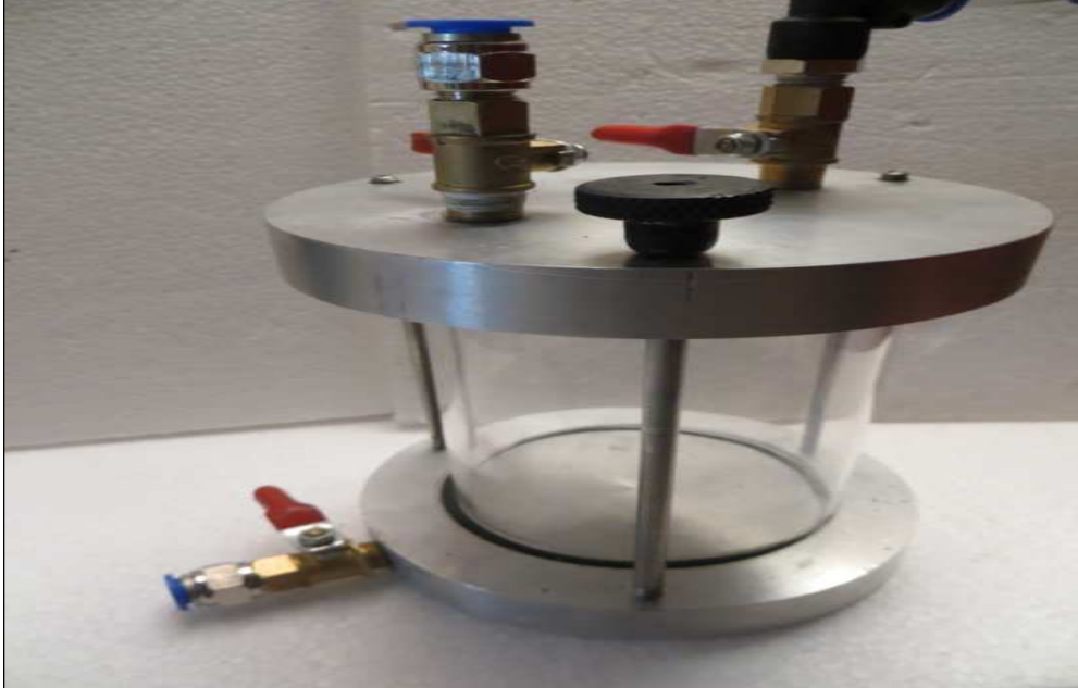
Figura 263. Molde más Válvulas y Perilla Tuerca para el Ajuste del Molde con las Tapas y Garantizar que no Quede Fuga de Agua.
