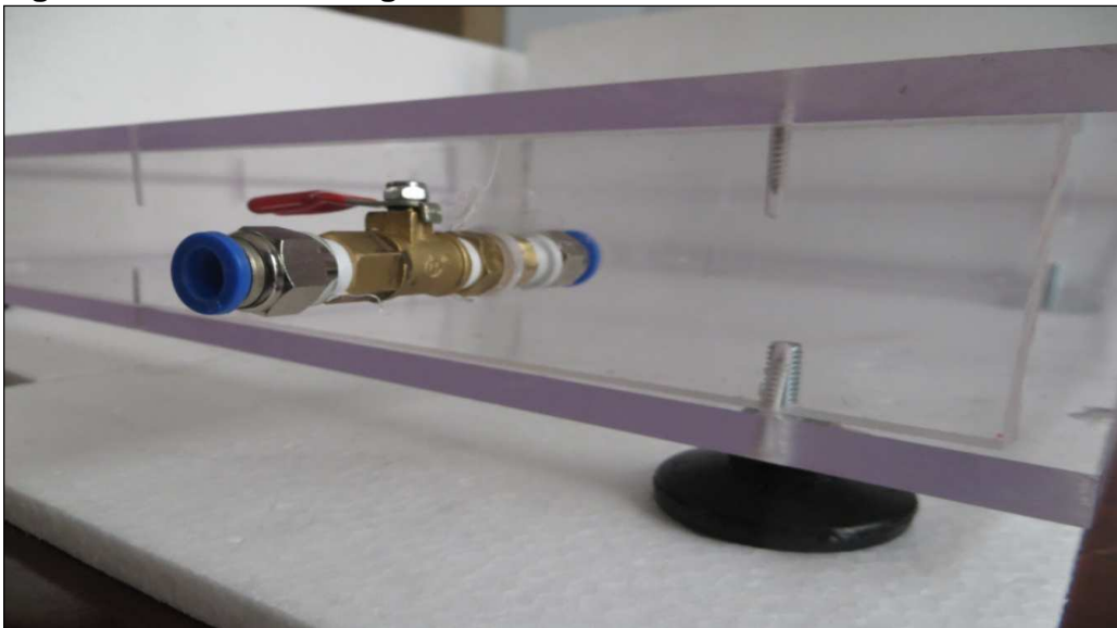
Figura 15. Entrada de Agua.
