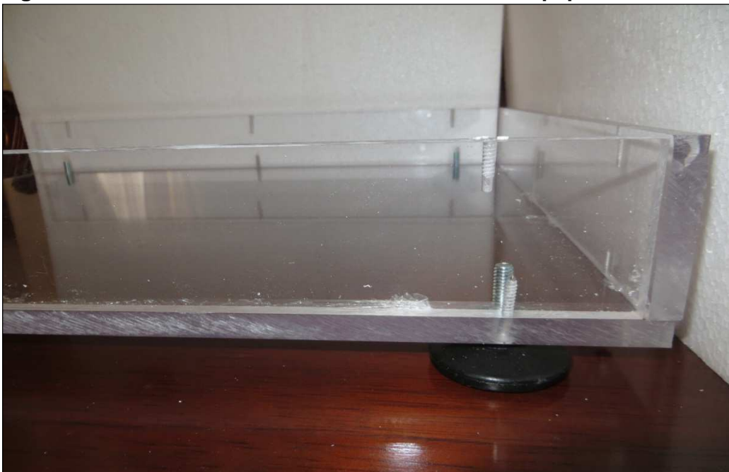
Figura 11. Niveladores Colocados en la Base del Equipo
