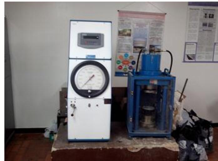
Ilustración 2. Prensa Hidráulica Instalaciones del Laboratorio de Concretos Universidad Católica de Colombia
