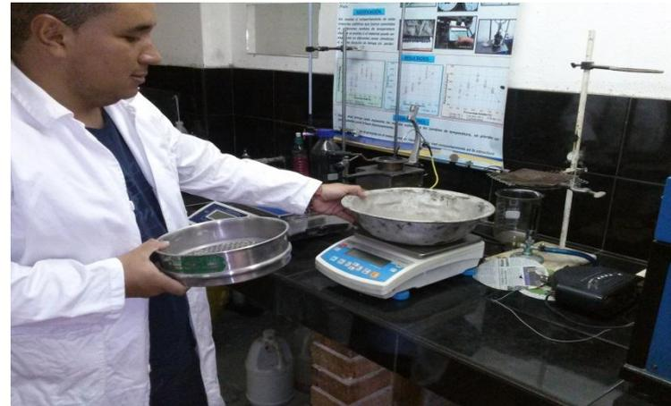
Ilustración 6 análisis granulométrico (ntc 77 y 78)
