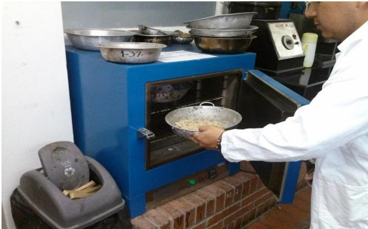
Ilustración 5 - densidad y absorción del agregado fino (ntc 237)
