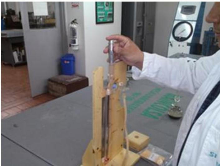
Ilustración 3 finura del cemento por medio del equipo de blaine (ntc 33)
