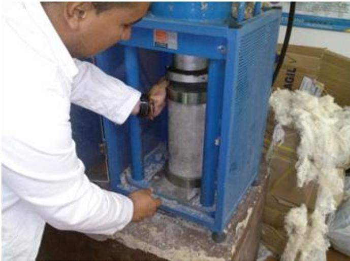
Ilustración 5 - compresión de cilindros de concreto
