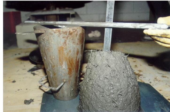
Ilustración 6 asentamiento del concreto
