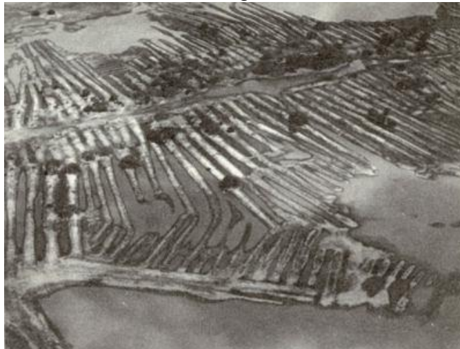
Figura 28. Canales construidos por los indígenas Zenúes sin obstaculizar el flujo del agua.
