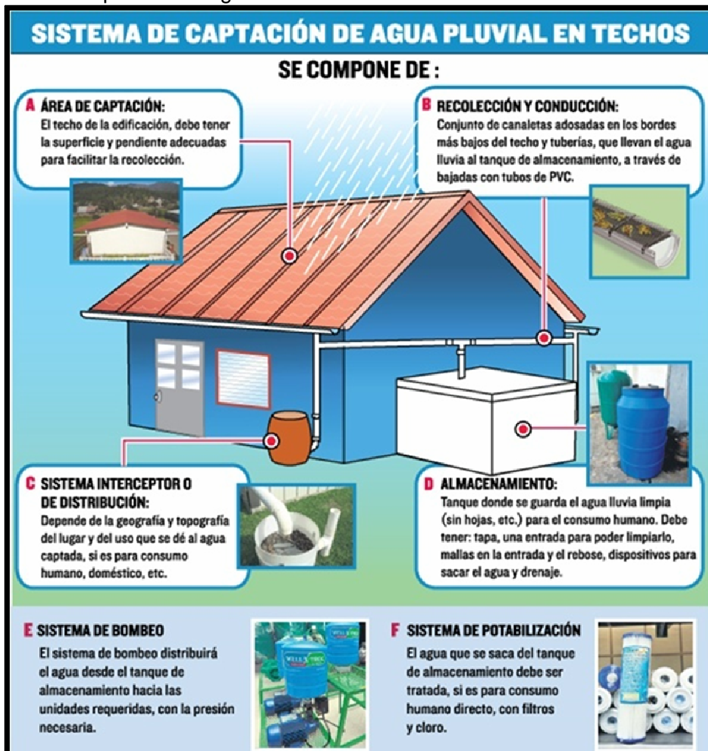
Figura 25. Captación de agua lluvia en techos.
