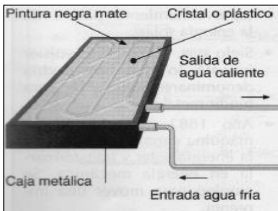
Figura 15. Partes de un colector solar
