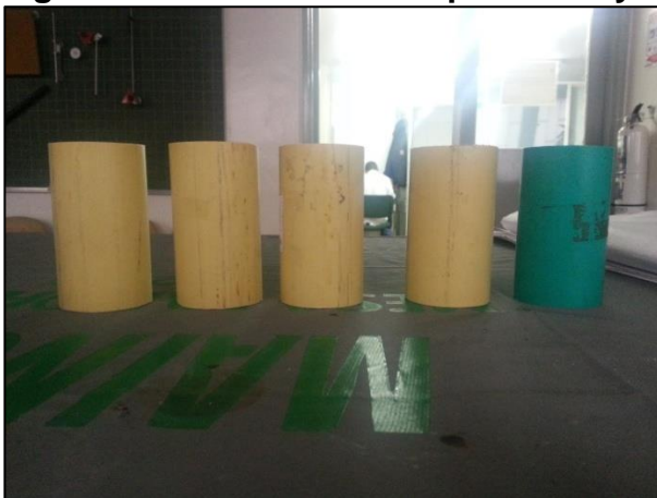
Figura 8. Probetas en PVC para Ensayo Compresión Inconfinada
