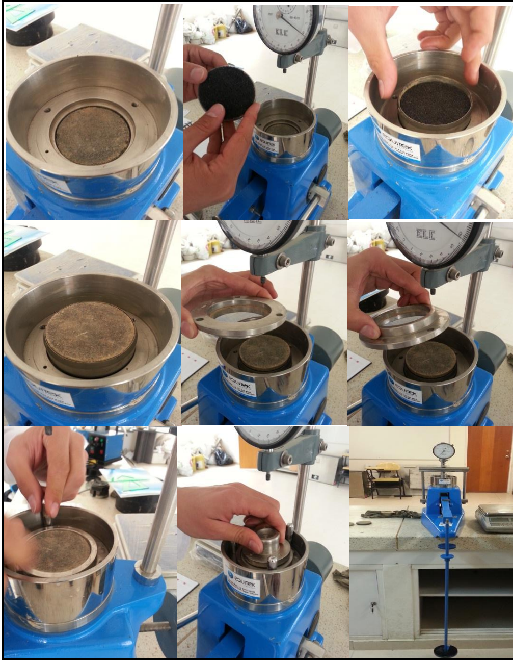
Figura 21. Montaje de la Muestra en el Equipo de Consolidación Unidimensional
