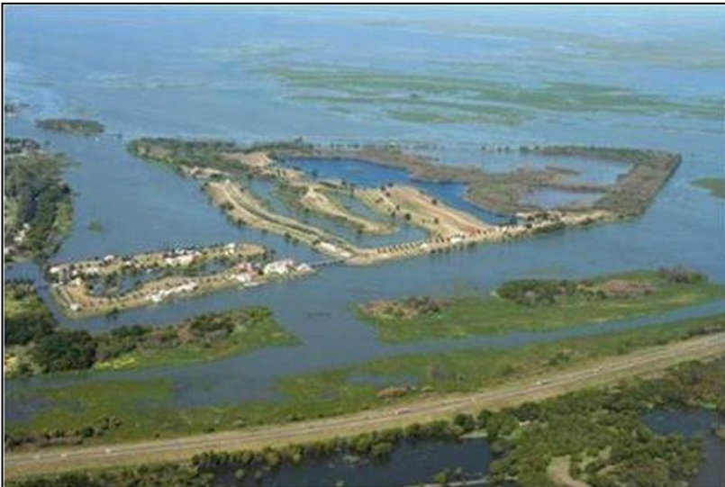
Figura 7. Montículos Artificiales de Tierra que Evitan la Inundaciones
