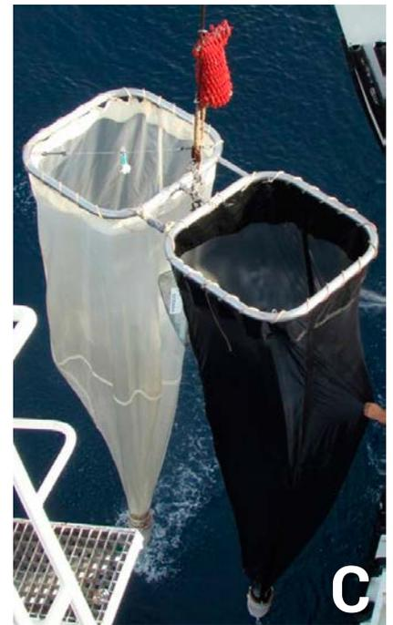
**Figura 1.6:** Muestreadores empleados en muestreos de plancton. **A:** Botella oceanográfica. **B:** Red de plancton Bongo 40. **C:** Red de plancton Bongo 90.
