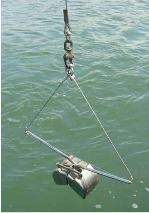
Figura III- 1: Muestreador de sedimento tipo van Veen.
