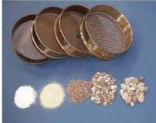
Figura III- 11: Tamices de distinta luz de malla y ejemplos de tamaño de grano. (Fuente: ce.memphis.edu)
