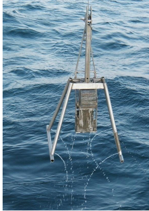
Figura III- 2: Muestreador de sedimento tipo Box-corer.
