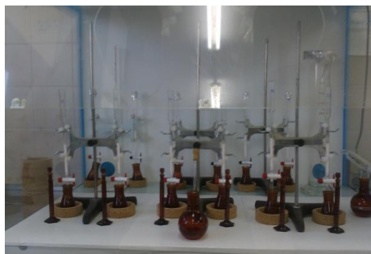
Figura III- 10: Esquema y fotografía del proceso de limpieza en columna cromatográfica.
