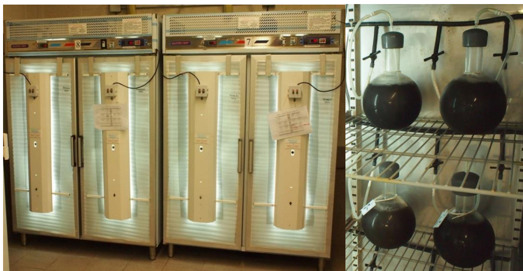
Figura 3. Cultivo en laboratorio de gametófitos de laminarias en botellones dentro de cámaras de simulación ambiental. Esta fase microscópica del ciclo de vida de laminarias actúa como un banco de germoplasma o de “semilla” con el que se puede obtener plántulas.
