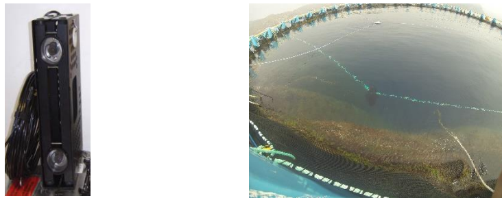
Fig. 2. Imagen del sistema estereoscópico antes de sumergirlo (izquierda). Imagen del sistema de cámaras estereoscópicas realizando mediciones en una de las jaulas (derecha).
