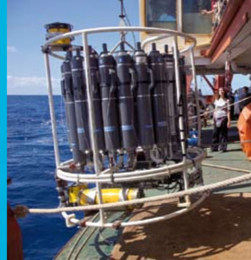
Maniobra de recuperación de la roseta después de que recogiera en una estación numerosas muestras de agua y miles de datos oceanográficos (temperatura, salinidad, etc.) a diferentes profundidades. JOAN COSTA - CSIC • Recovery of the rosette after it has collected many samples of water and thousands of items of oceanographic information (temperature, salinity, etc) in one location at different depths. JOAN COSTA - CSIC
