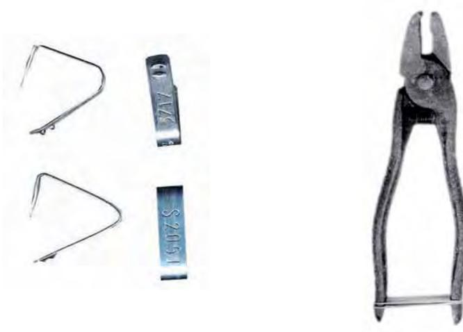
**Figura 2.12.** Marcas metálicas tipo Monel 400 y el alicate especial utilizado para marcar tortugas marinas. Foto X. Valeiras.
