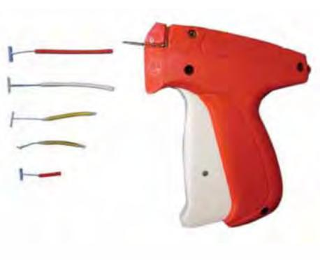
**Figura 2.6.** Marcas de distintos tamaños del tipo dardo (T-bar) y pistola utilizada para insertar las marcas. Foto C. Rodríguez-Cabello.
