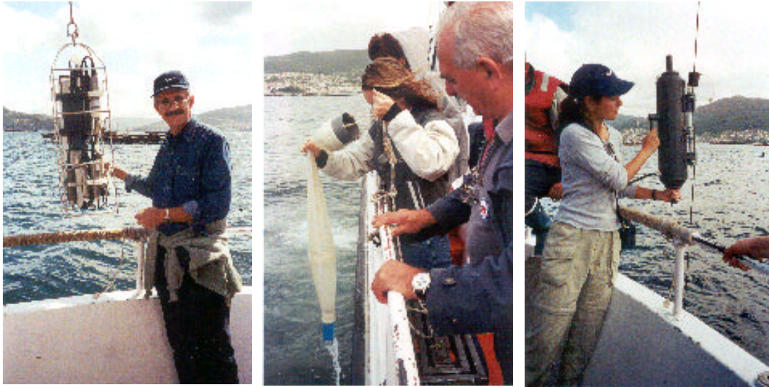
Fig. 9. Izquierda: sonda CTD sujeta por el torno oceanográfico a punto de ser lanzada. Centro: pequeña red de plancton de 10 \mu\text{m} de apertura de malla, con aro de sujeción y colector de PVC. Derecha: botella oceanográfica de 5 l, sujeta por el torno oceanográfico (Fotos de M. Lion tomadas a bordo del B/O "J.M. Navaz", en la Ría de Vigo, durante el "V Curso COI-AECI-IEO sobre Fitoplancton Tóxico y Ficotoxinas", junio de 2001).
