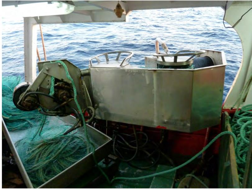
Figura 8.2.7.- Detalle del halador y del rasco.
