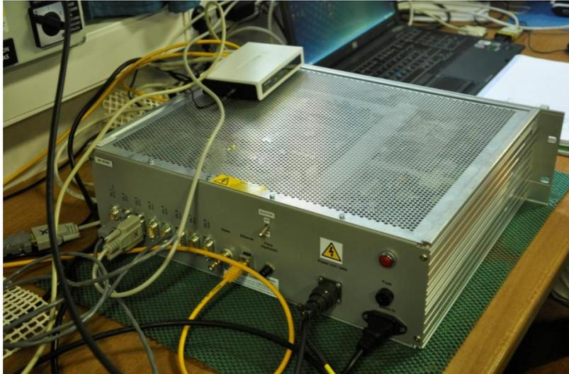
Figura 4.4.19. Unidad de cubierta en formato rack del Nexus
