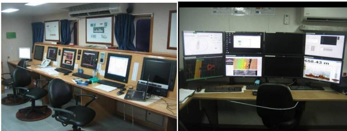
**Figura 4.3.2.** Laboratorios de geofísica del B/O Miguel Oliver (izquierda) y del B/O Ángeles Alvariño (derecha).
