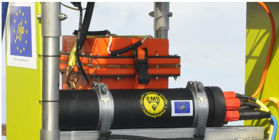
**Figura 4.4.18.** Equipo Nexus MK-E multiplexor
