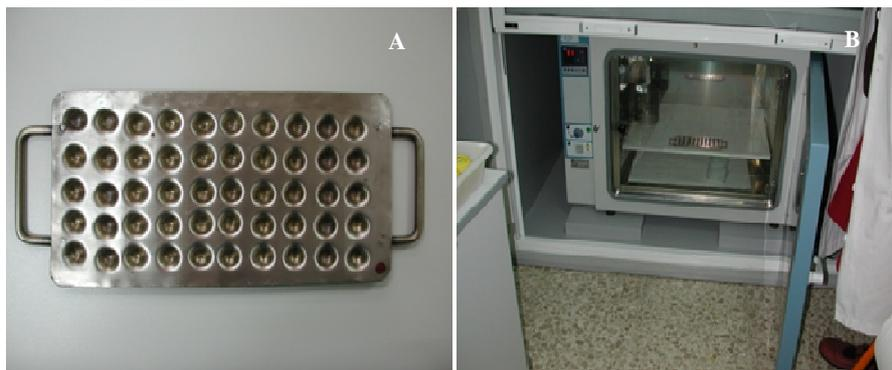
**Figura 9.** Placa para tostar otolitos (A). Estufa donde se tuestan los otolitos a diferentes temperaturas (B).
