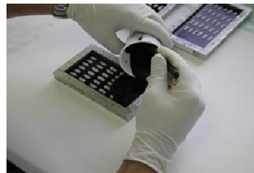
4. Con la maquina cortadora se hacen los cortes del bloque obteniéndose tiras cuyo grosor varía en función de las características del otolito y del estudio a realizar (entre 0.7-1 mm).
