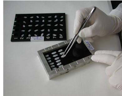
3. Los otolitos se cubren con una segunda capa de resina y, se deja endurecer el bloque durante 24 horas para posteriormente sacarlo del molde de metal y proceder al corte del mismo.
