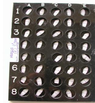
2. Se vierte una primera capa de resina en la base del molde de acero. Una vez endurecida (30 minutos), se marcan con un objeto punzante las líneas de referencia sobre la resina para colocar los otolitos. Se coloca el centro de los otolitos sobre dichas líneas marcadas.
