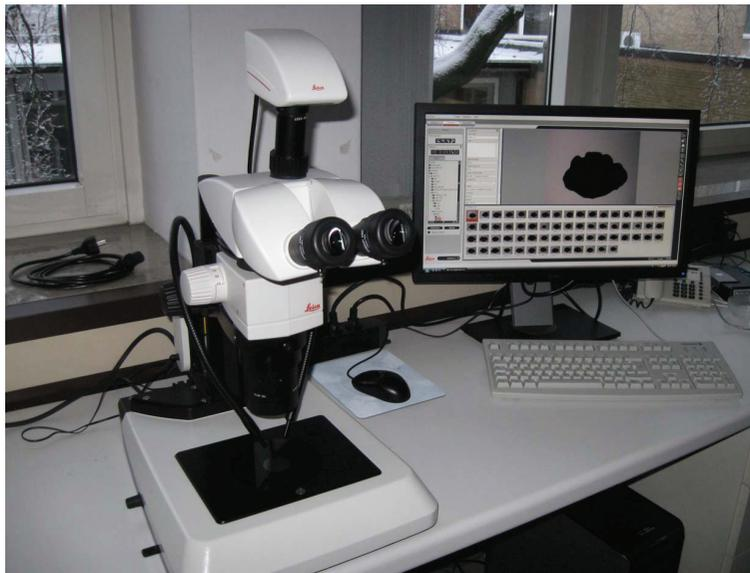
**Figura 4.2:** Sistema de análisis óptico usado para fotografiar los otolitos de *L. piscatorius*.
