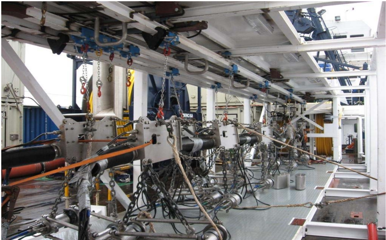
Foto 4. Estructura de cañones diseñada y fabricada por UTM.
