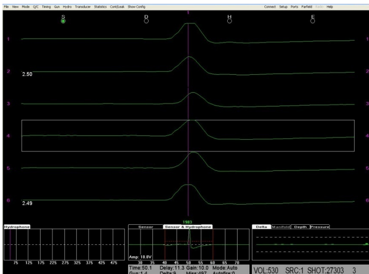
Figura 4. Detalle de funcionamiento del controlador de cañones y sincronía en la generación de la fuente sísmica.
