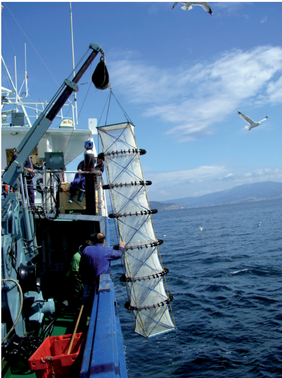
Figura 11.- Jaula diseñada para ayudar a soltar en profundidad (20 m) a las merluzas marcadas vivas.
