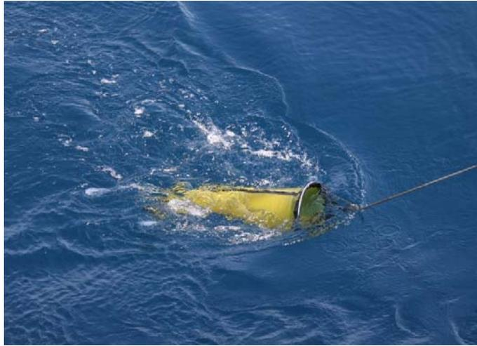
Se realizó todos los días la recolección de muestras de fitoplancton, a la vez que se efectuaba la estación de CTD. Para ello, mediante la utilización de una red de fitoplancton de 20 micras se recogieron muestras de la columna de agua hasta 50 m de profundidad. Las muestras fueron fijadas y etiquetadas para su posterior estudio en la Universidad de El Salvador.
