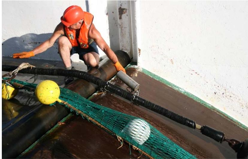
En todas las pescas realizadas en la campaña se utilizó un colector metálico acoplado a la red, generalmente en los calones, para recoger muestras de sedimentos.
