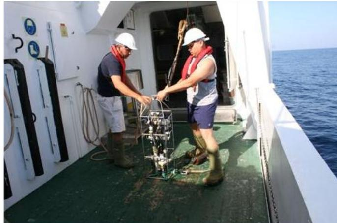
Con el objeto de estudiar las condiciones oceanográficas de la zona de estudio, después de cada pesca, se utilizó una batisonda CTD, modelo SeaBird 25 provisto de los sensores de presión, temperatura, conductividad y oxígeno.
