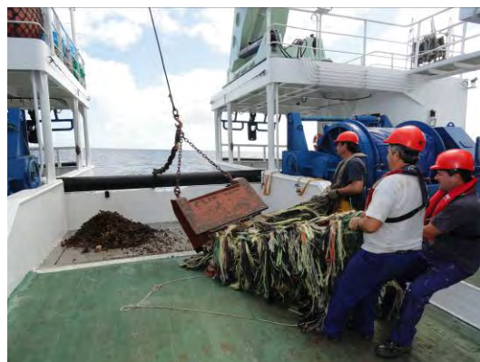
Figura 3.25. Izquierda, draga de roca utilizada en la campaña DRAGO 0511. Derecha, volcado de la draga 01 en la cubierta de popa del B/O Miguel Oliver.
