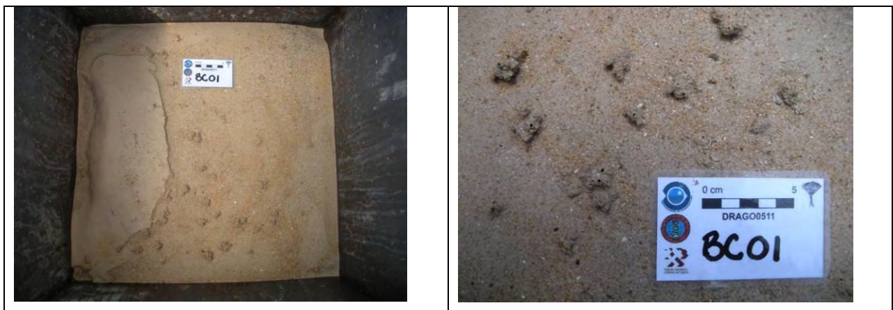
Figura 5.14. Aspecto de la superficie del fondo muestreada mediante la draga Mega Box-Corer.
