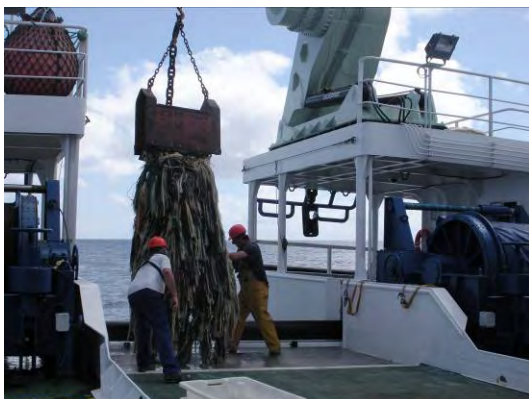
Figura 3.25. Izquierda, draga de roca utilizada en la campaña DRAGO 0511. Derecha, volcado de la draga 01 en la cubierta de popa del B/O Miguel Oliver.
