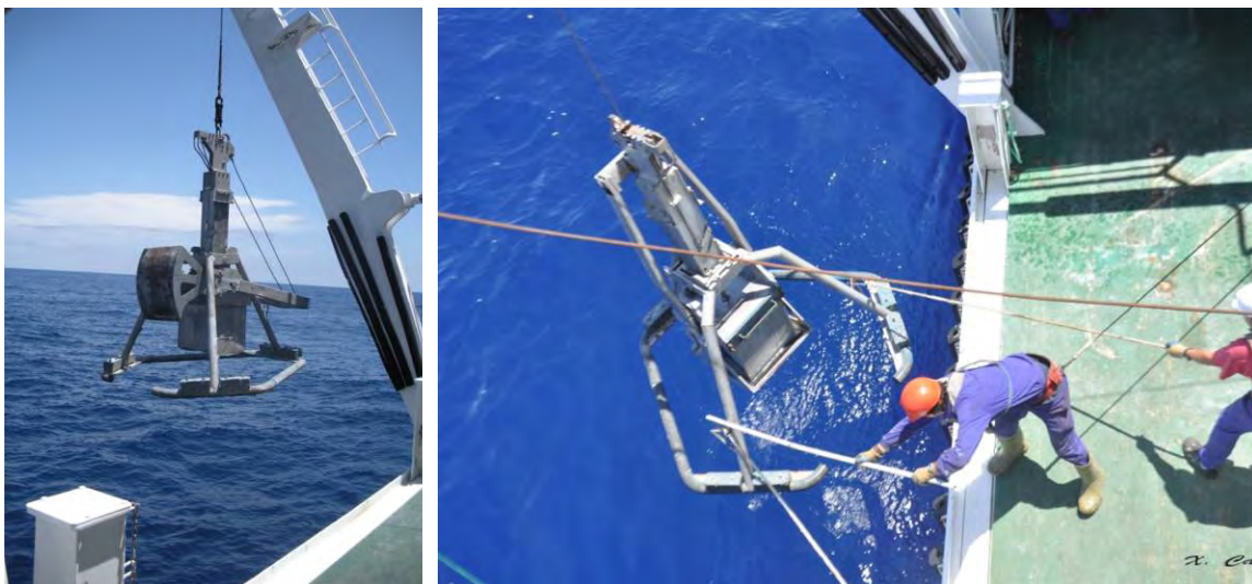
Figura 3.28. Draga Mega Box-Corer durante la maniobra de muestreo de sedimentos superficiales.
