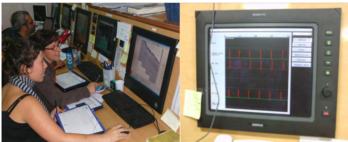
Figura 3.21: Científicos supervisando la adquisición de datos en tiempo real del sistema TOPAS PS 18 durante la Campaña DRAGO 0511 (izquierda). Unidad de sincronía entre las ecosondas Multihaz EM 302m Monohaz EA 600 y la sonda paramétrica TOPAS PS 18 (derecha).
