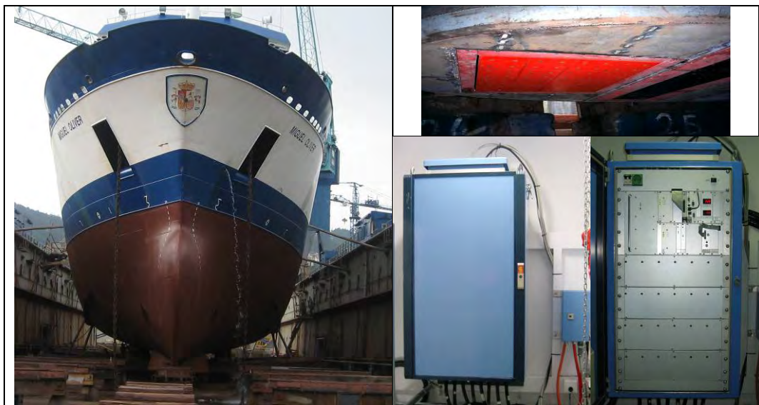
Figura 3.16: Izquierda: Imagen de la barquilla de sondas del B/O Miguel Oliver. Derecha superior: Subsistema de Transductores de la TOPAS en la barquilla. Derecha inferior: Transceptores en el interior del buque.
