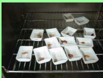
DESECACIÓN EN ESTUFA ( 105 \pm 1^\circ\text{C} )
