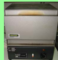
INCINERACIÓN EN MUFLA ( 450 \pm 2^\circ\text{C} )
