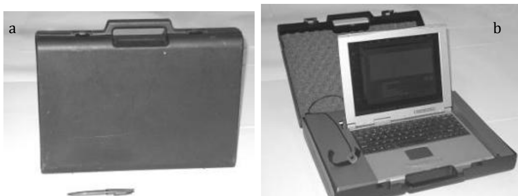
Att.31. Pārnēsājama portatīva PPG iekārta a) aizvērtā stāvoklī, b) atvērtā.
