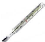
Instrumentos que possuem um reservatório (bolbo) associado a um tubo capilar de vidro onde se encontra o líquido termométrico - que enche completamente o reservatório e parcialmente o tubo capilar - e uma escala graduada que permite ler o nível do líquido no tubo. Com as variações de temperatura, o líquido irá expandir-se ou contrair-se, subindo ou descendo pelo capilar. Devido a uma constricção no reservatório, o líquido apenas volta à temperatura inicial após o instrumento ser agitado.
