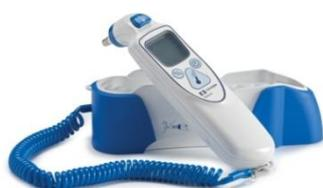
Instrumentos que medem a radiação térmica da membrana timpânica ou da superfície da pele na têmpora. Possuem uma lente que concentra a radiação infravermelha num detetor que, por sua vez, a converte num sinal elétrico.
