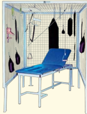
Figura 13: Gaiola de Rocher. Este dispositivo permite, através da conveniente adaptação de roldanas e pesos, a realização dum leque alargado de exercícios terapêuticos.
