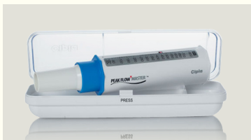
Figura 4: Medidor do pico de fluxo expiratório, que determina a pressão gerada voluntariamente durante a tosse.
