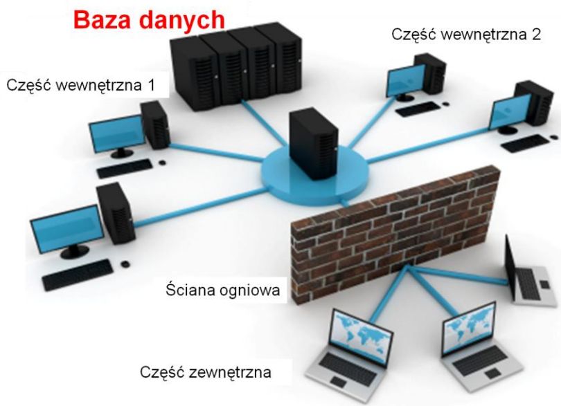
Rysunek 4.18. Podział systemu medycznego na część wewnętrzną i część zewnętrzną, odgradzoną „ścianą ogniową”. Baza danych bezwarunkowo powinna być w zabezpieczonej części wewnętrznej (Źródło: http://www.ganzetech.com/images/network_sec.jpg - sierpień 2010)
