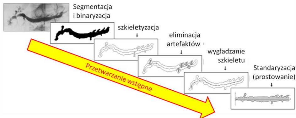
Rysunek 7.11. Przykładowa sekwencja przetwarzania obrazu medycznego przed jego analizą i rozpoznawaniem
