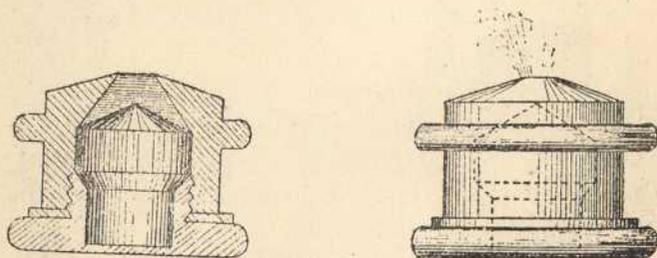
*Figs. 6<sup>a</sup> y 7<sup>a</sup>—Aparato pulverizador propiamente dicho*
