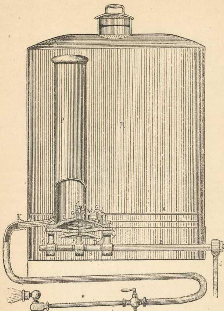
Fig. 14—Corte vertical del aparato Vermorel
