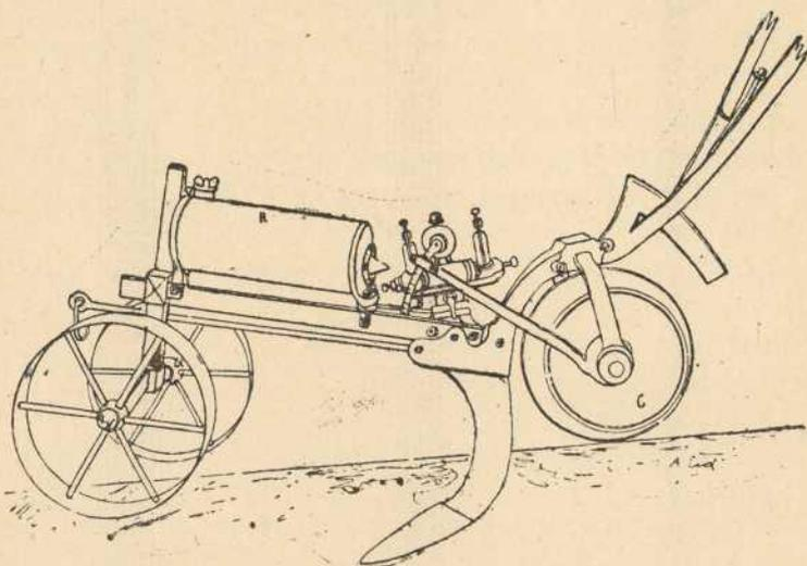
Fig. 57—Inyectador de tracción de Mr. Gastine.
