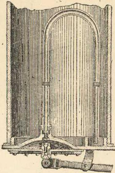
*Fig. 12—Corte vertical del aparato Noël*
