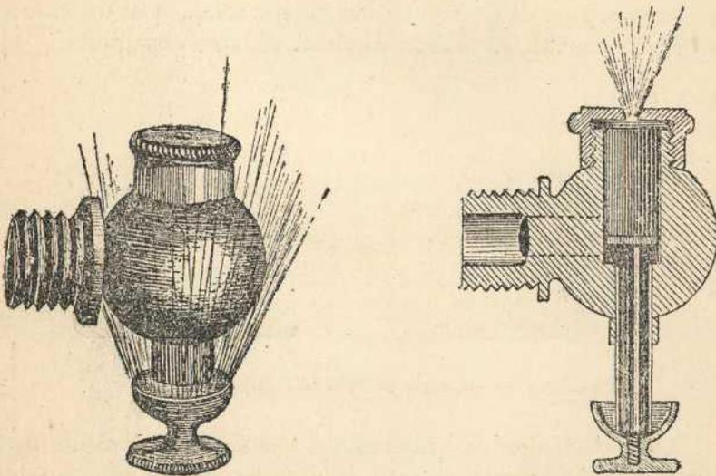
Figs. 4<sup>a</sup> y 5<sup>a</sup>—Pulverizador Vermorél
