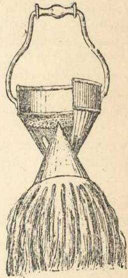
*Fig. 21 -Azufrador S. Pierre (parte interior)*
