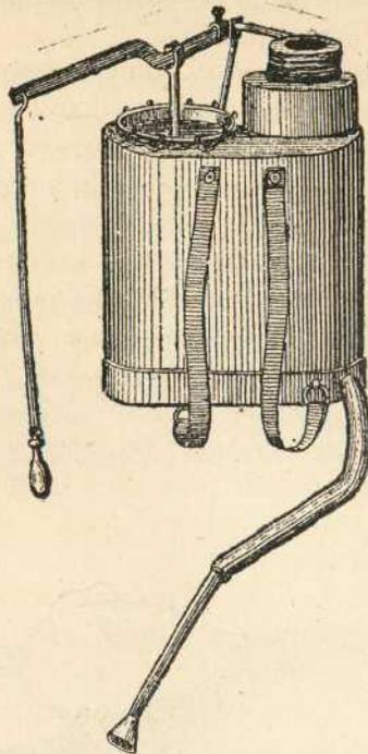
*Fig. 18--Azufradora y espolvoreadora «Torpedo»*
