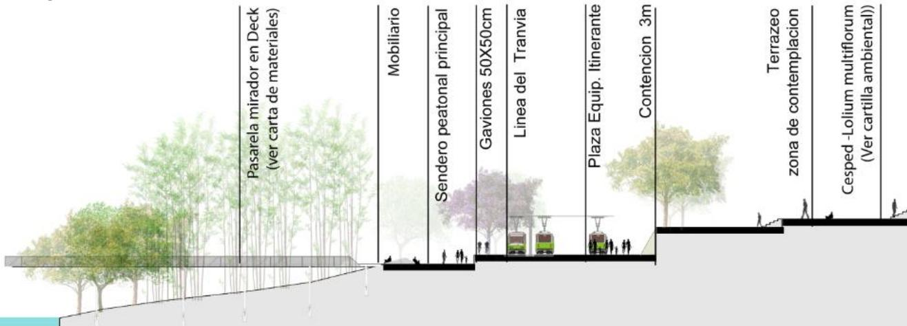
En este corte se evidencia el eje principal con sus senderos y paso de tranvía un área paisajística y de contemplación y el remate con miradores.
