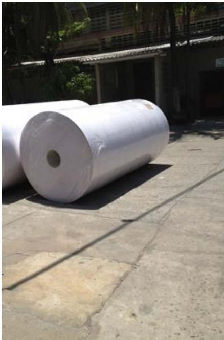
Ilustración 4. Rollo de papel tisú listo para ir a la sección de Conversión. (Unibol S.A)
