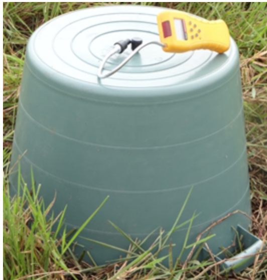
Figura 2. Foto de uno de los tanques de agua con el medidor de metano “GPT100 Portable Gas Detector”.
