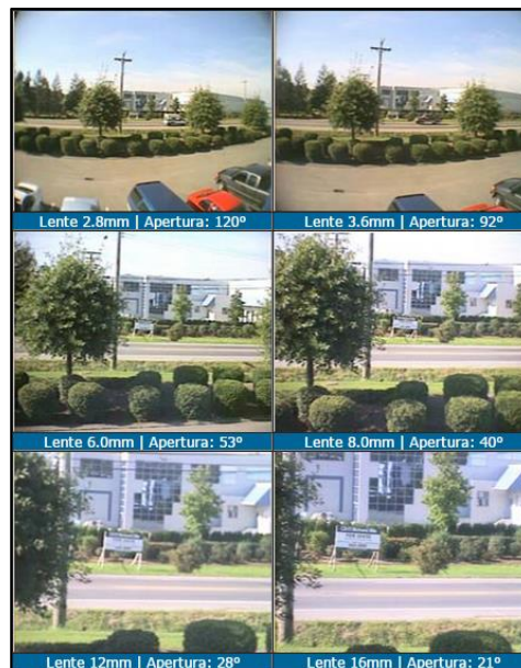
Ilustración 14. Ángulos de apertura de un lente, tomada de (Calcom, 2014)
