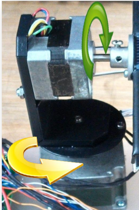
Figura 12. Esquema seguidor solar con dos grados de libertad.
