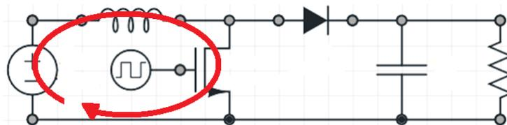
Fig. 11. Convertidor Boost: Interruptor encendido
