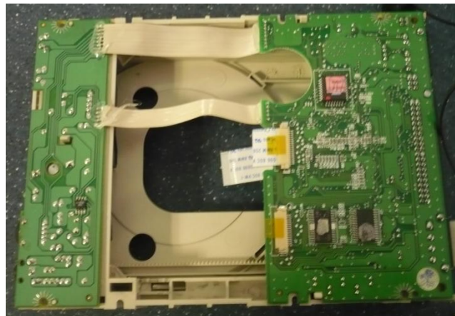
Figura 18: Circuito y bandeja del Lector de CD de un computador de escritorio
